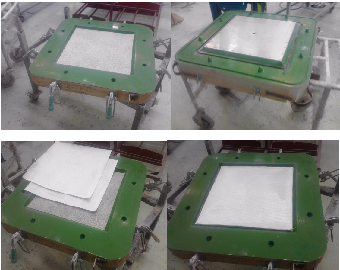
Obr. 26 Pohledy na RTM formu a výztužné materiály
