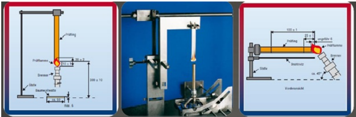
Obr. 24 Ukázka uspořádání testovací metody UL 94 [30]
