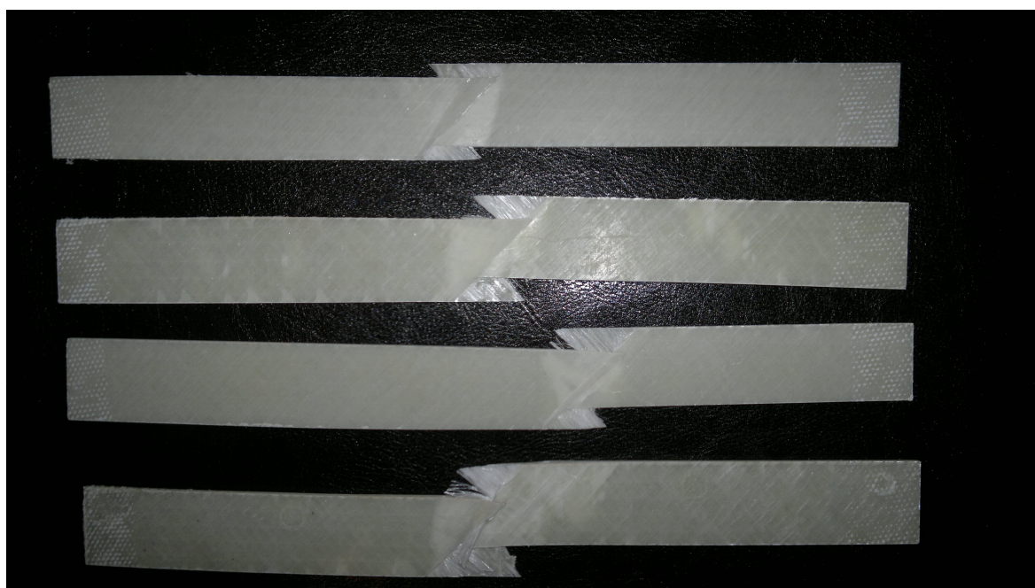
Obr. 35 Vzorky po zkoušce tahem
