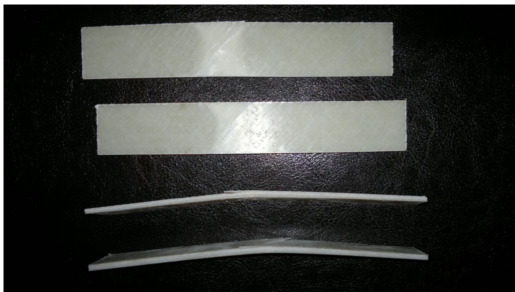
Obr. 41 Vzorky po provedené zkoušce ohybem
