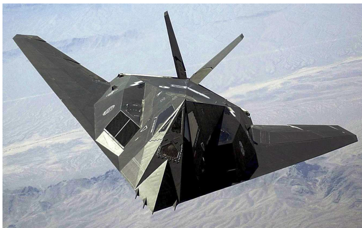
Obr. 15 Stíhací letadlo Stealth F117 US Army s kompozitním pláštěm [6]
