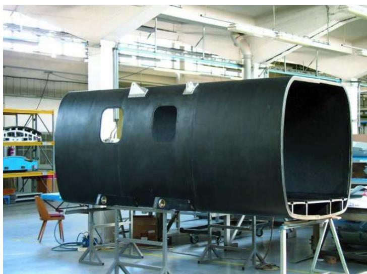
Obr. 10 Celokompozitní trup dopravního letadla [6]
