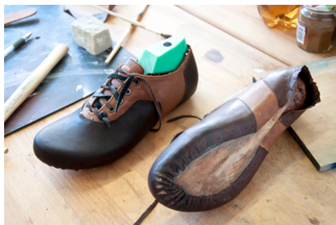
obr. č. 42 Zkouška technologie prošívání
