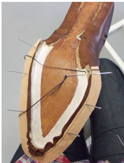
Obr. 27: Našívání rámků a napnutého svršku na žebro.
