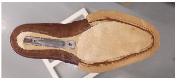
Obr. 28: Nalepený klének a půdování.
