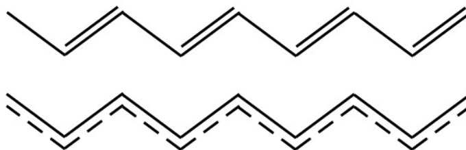
Obrázek 1 Schématický vzorec trans-polyacetylenů a jeho \pi -delokalizovaných elektronů [7].
