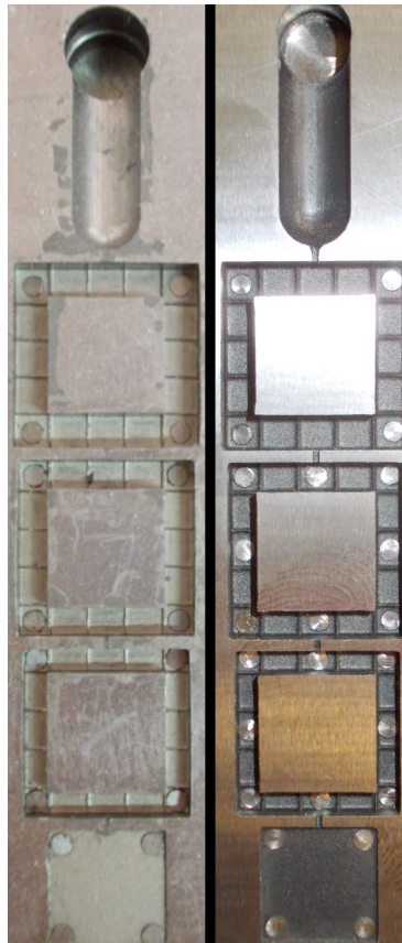
Obrázek 16 Dutina staré a nové formy
