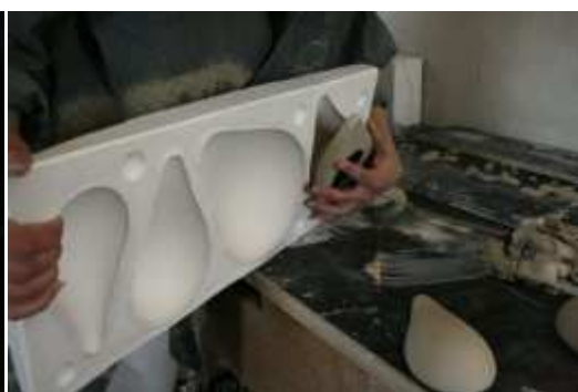
Obr. 12. Vyklopenie odliatku z formy
