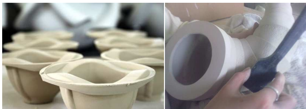
Obr. 13. Odliatok vytiahnutý z formy
