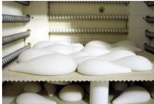
Obr. 15. Porcelánové (biskvitové) výrobky po prvom pálení
