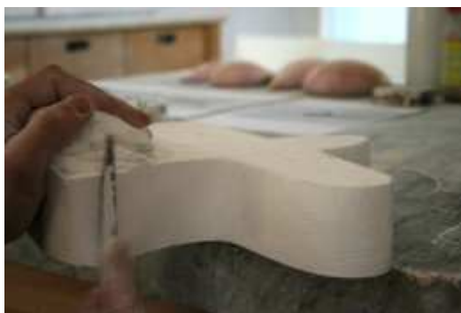
Obr. 7. Výroba sadrového modelu
