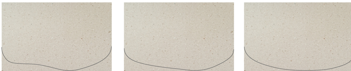
Obr. 36. Tvary vrchních klop krabic – Cutulum, SFS, univerzální
