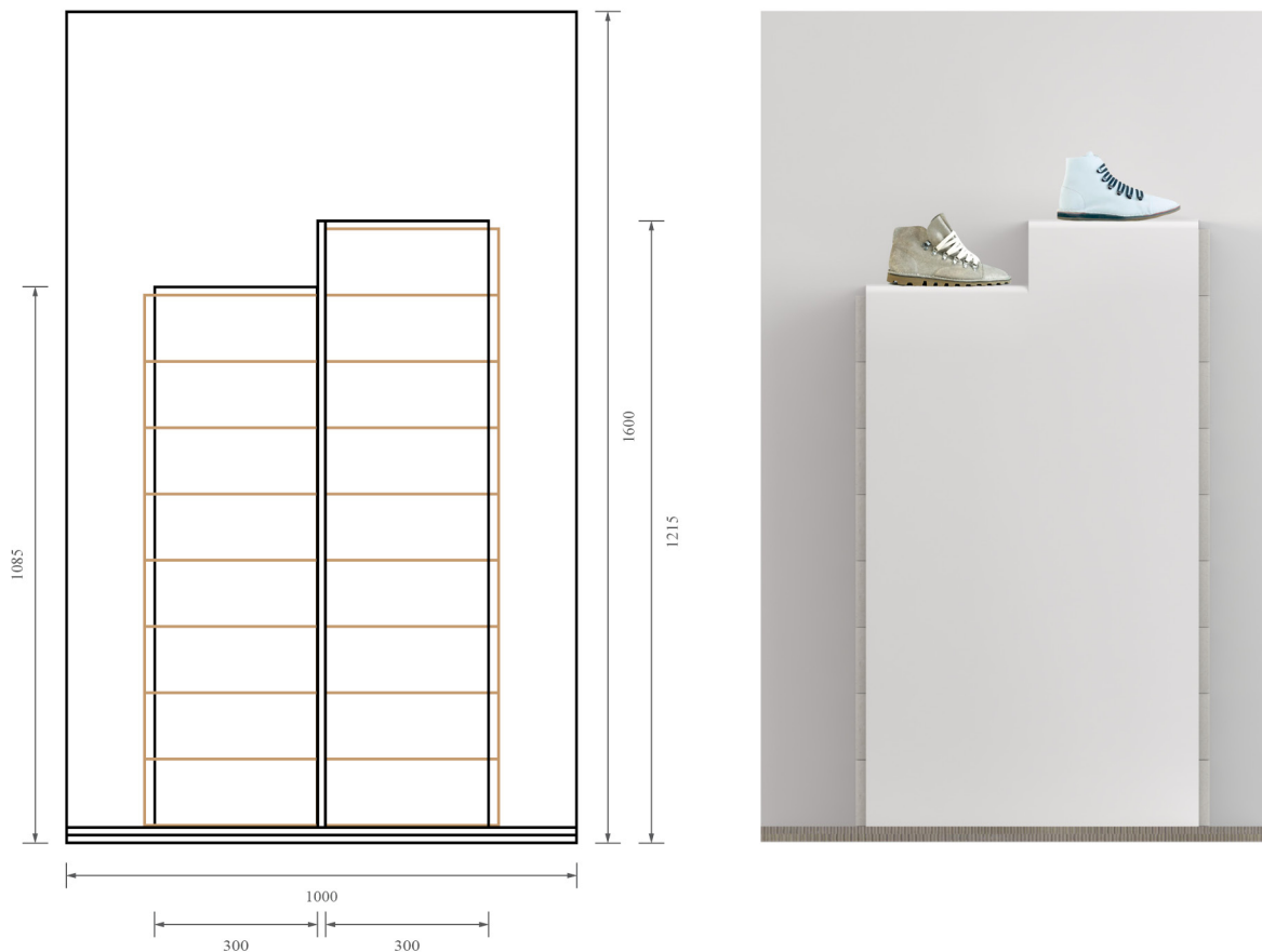
Obr. 43. Stojan na dvě boty – rozměry v mm
