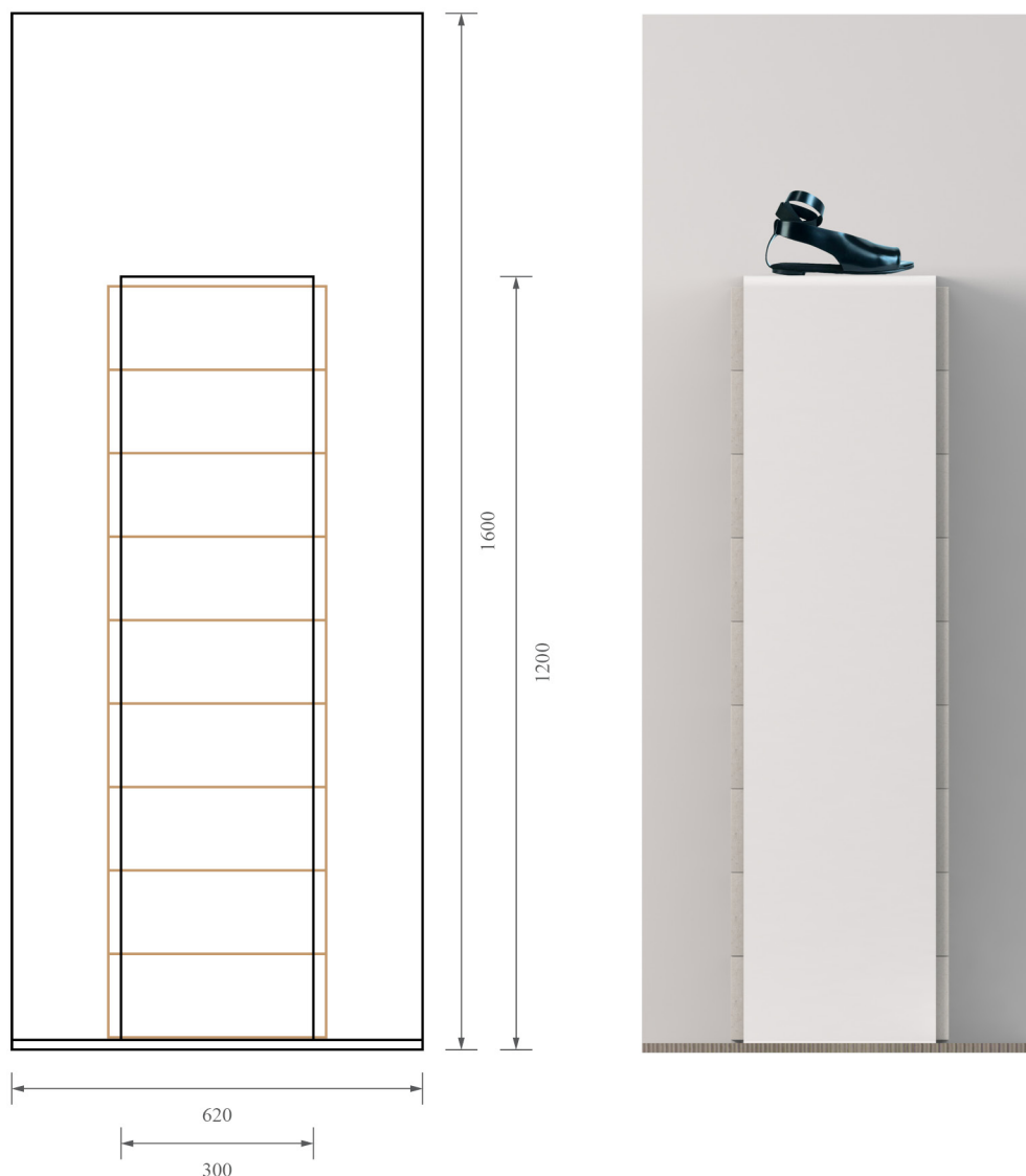
Obr. 40. Stojan na jednu botu – rozměry v mm
