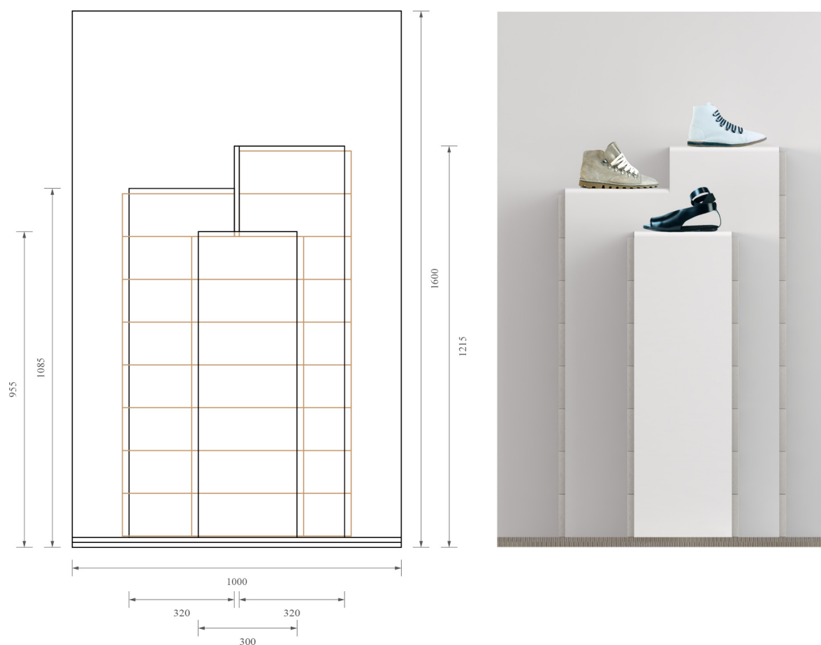
Obr. 46. Stojan na tři boty – rozměry vmm
