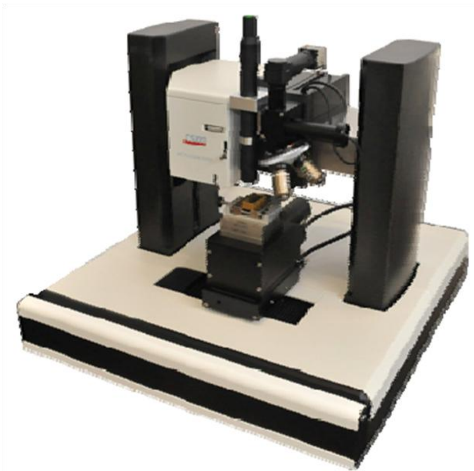
Obr. 8.4 Mikrotvrdoměr – Micro Combi Tester
