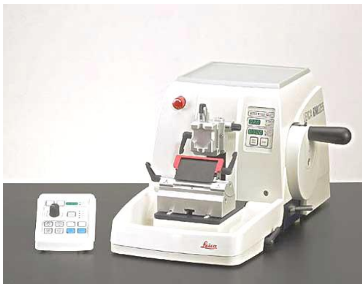
Obr. 8.7 Rotační mikrotom Leica RM 2255
