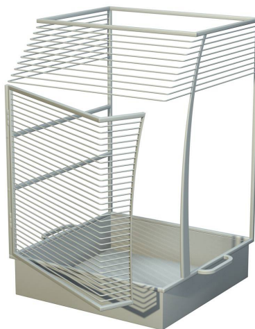
Obr. 63: Rám s pootvřenými rohovými dveřmi a základní mřížkou.
