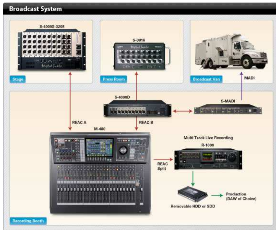
(obr.28 schéma zapojenia a digitálnej distribúcie signálu)
