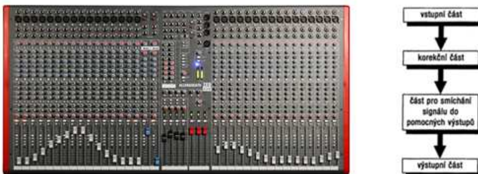
(obr. 4 mixážny pult Allen & Heat a jeho zjednodušený popis)
