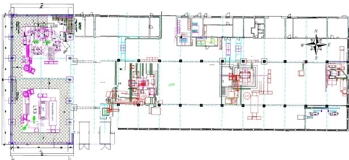
Obr. 42 Finální layout budovy 72 s umístěním dvou nových kovacíh linek (zdroj: vlastní zpracování)
