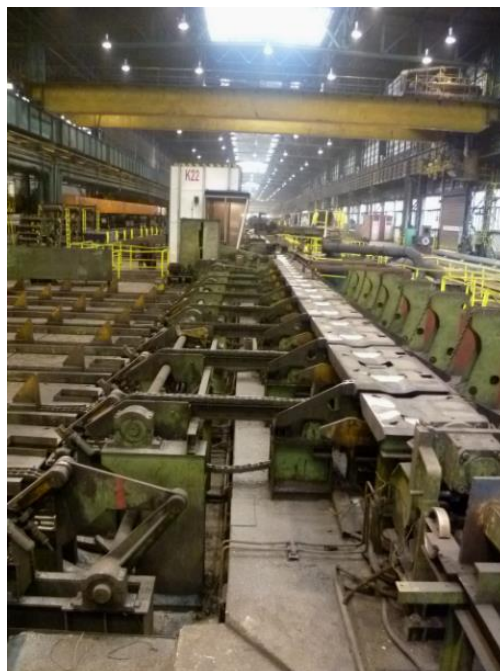
Obr. 31. Zpětný pohled na doúpravnu z úrovně ukládacího zařízení, v popředí dopravník a za ním rozbrušovací pila. (Vlastní zpracování)
