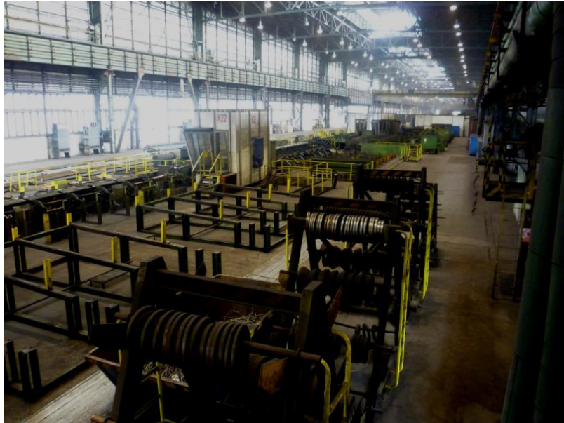
Obr. 30. Boční pohled na doúpravnu z úrovně mezi rovnačkami typu UFR 7 x 400 a UFR 9 x 250 a rozbrušovací pilou, v popředí kompletační rošty. (Vlastní zpracování)
