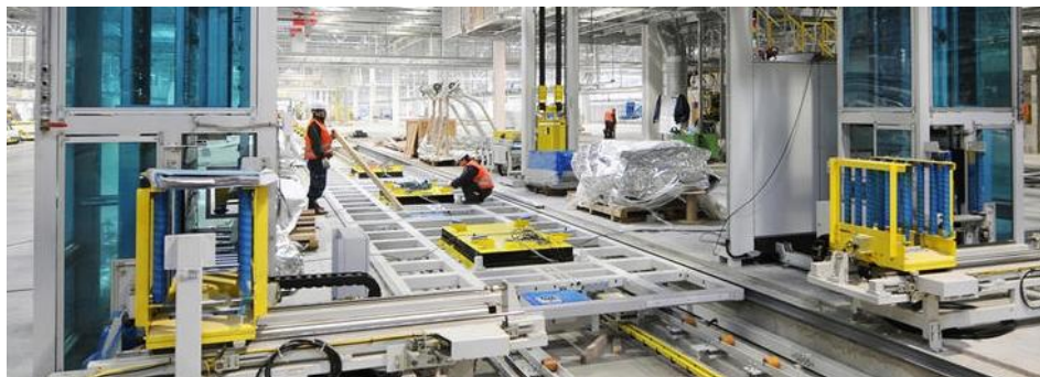
Obrázek 7 Využití skiletu v automobilovém průmyslu (CONDUCTIX, 2014)
