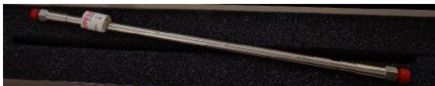
Obrázek 8 Kolona: Discovery C 18 (250 x 4,6 mm; 5 \mu\text{m} , Supelco, USA)
