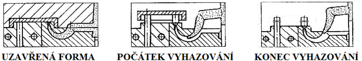
Obr. 22. Schéma tunelového banánového vtoku [3]
