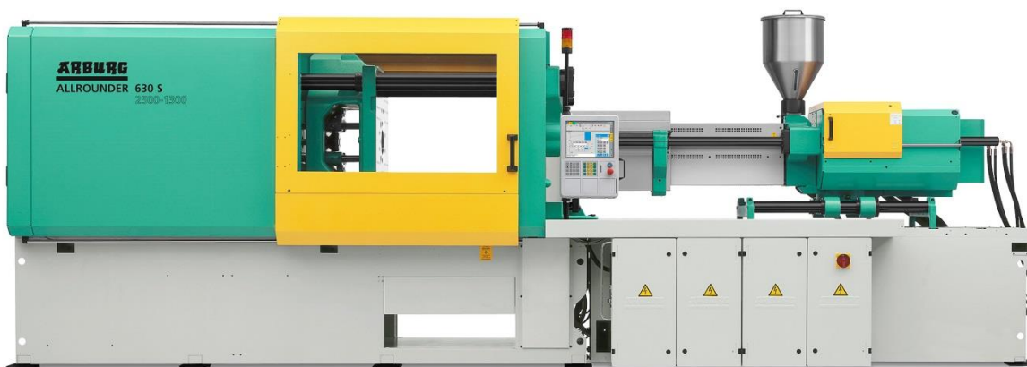
Obr. 43. Vstřikovací stroj ALLROUNDER 630 S [20]
