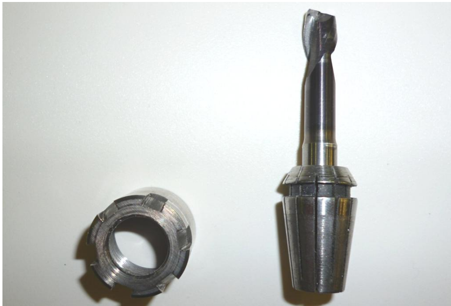
Obr. 18 Příklad upínací hlavičky pro frézu D8R1
