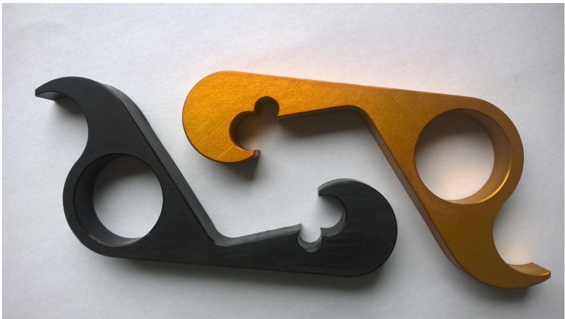
Obr. 57 Otvíráky po mechanické úpravě a eloxování
