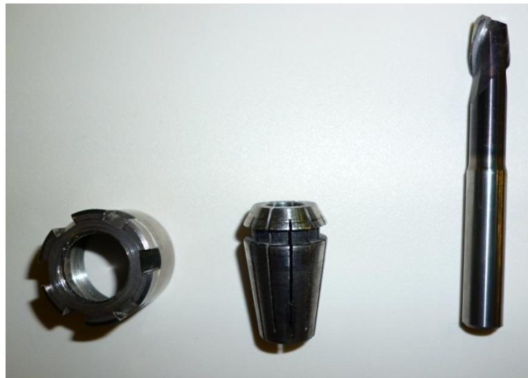
Obr. 47 Šroub, kleština a nástroj
