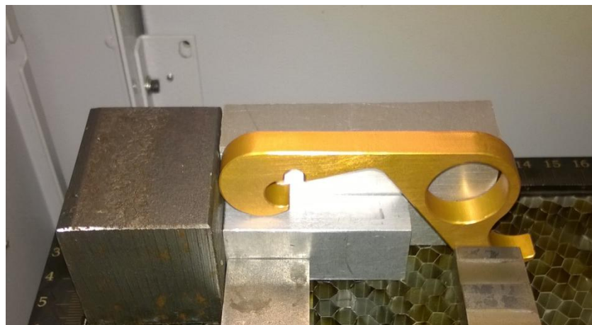
Obr. 59 Ustavení výrobku pro gravírování
