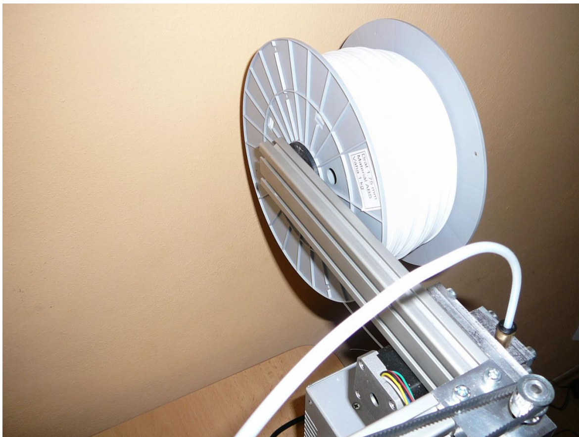
Obr. 34 Držák cívky s již nasazenou špulkou bílého materiálu ABS
