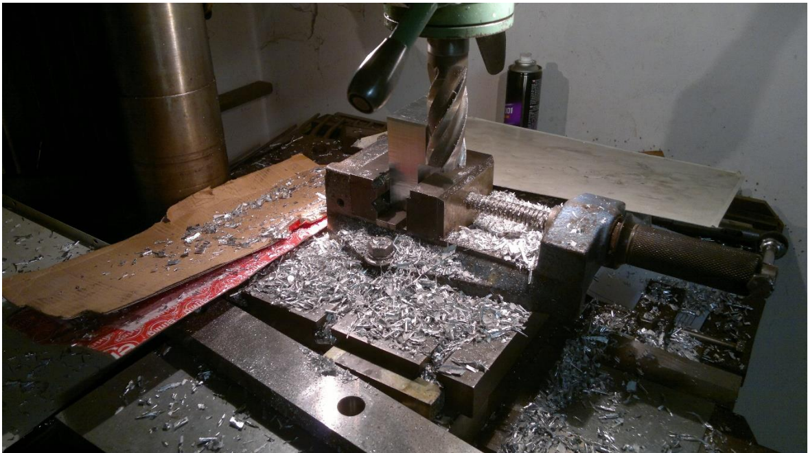
Obr. 17 Stojanová vrtačka použitá jako frézka
