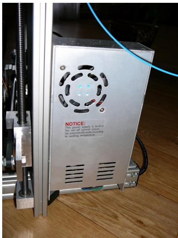
Obr. 37 Průmyslový 12V zdroj o výkonu 350W
