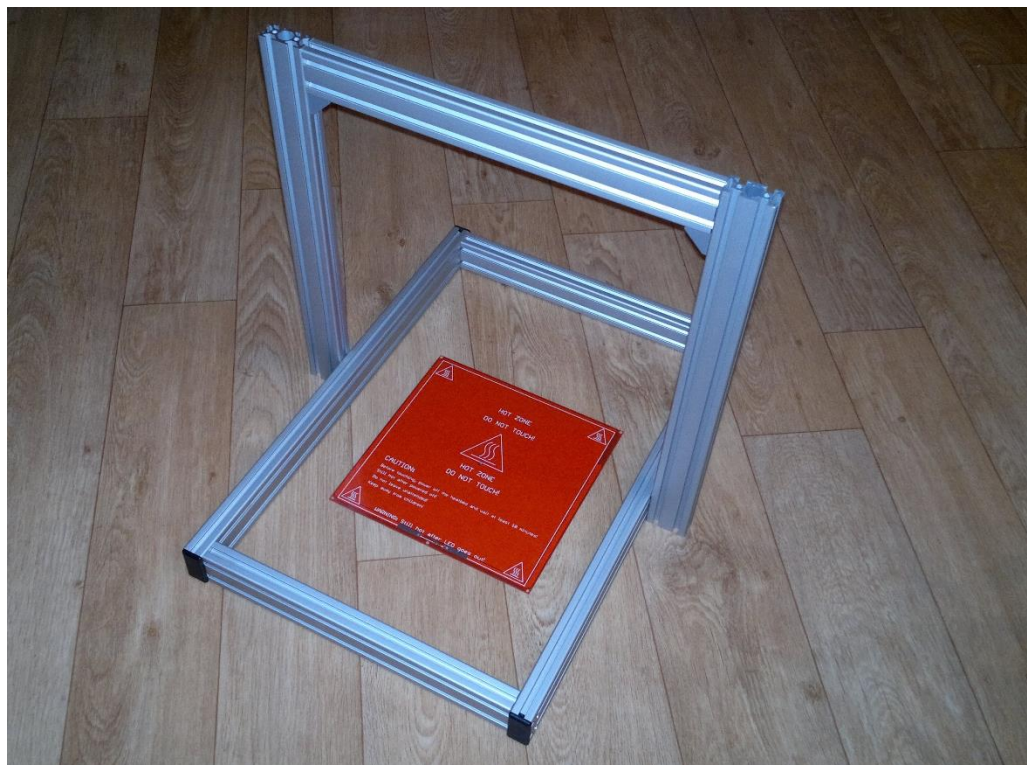
Obr. 20 Postupné sestavování rámu tiskárny.
