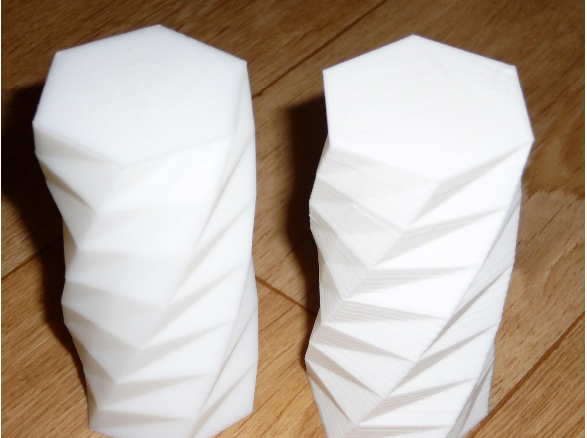
Obr. 44 Vytisknuté dílce k porovnání kvality tisku – vlevo součást vytvořena na komerčním zařízení, vpravo na vyrobené tiskárně
