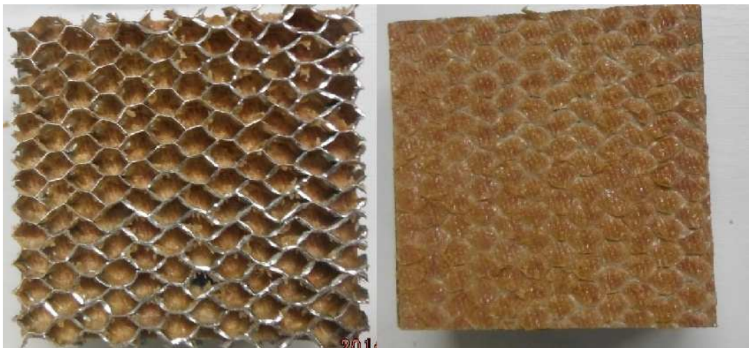
Obr. č. 41 Vzhľad vzoriek s Al voštinou stlačených na 9mm
