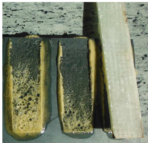
Obr. č. 32 Vzhľad po odhrnutí vzorky polyester- lep L3-kov
