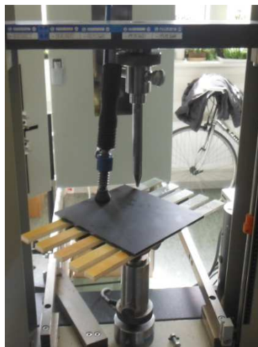
Obr. č. 18 Testovanie pevnosti zlepenia na stroji ZWICK materialprüfung 1456
