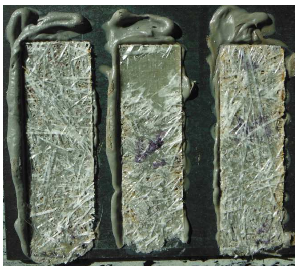
Obr. č. 28 Vzhľad po odrhnutí vzorky epoxid- lep L2-kov
