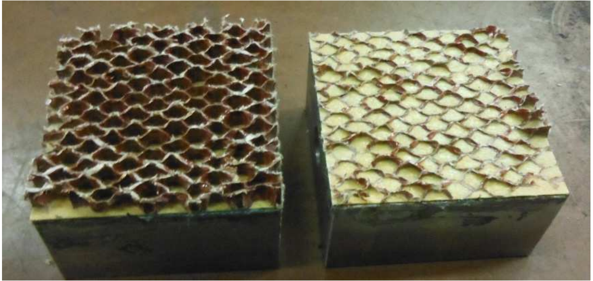
Obr. č. 47Vzhľad vzoriek s nomexovou voštinou stlačených na 9 mm
