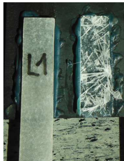
Obr. č. 20 Typický vzhľad po odtrhnutí vzorky Polyester-lep L1-kov
