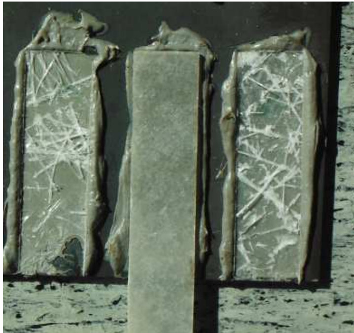
Obr. č. 26 Vzhľad po odrhnutí vzorky polyester- lep L2-kov
