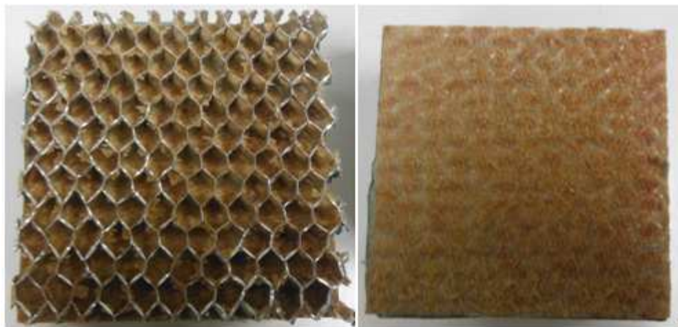
Obr. č. 39 Vzhľad vzoriek s Al voštinou stlačených na 10 mm
