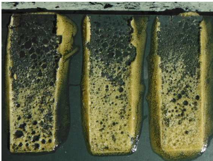
Obr. č. 34Vzhľad po odrhnutí vzorky epoxid- lep L3-kov
