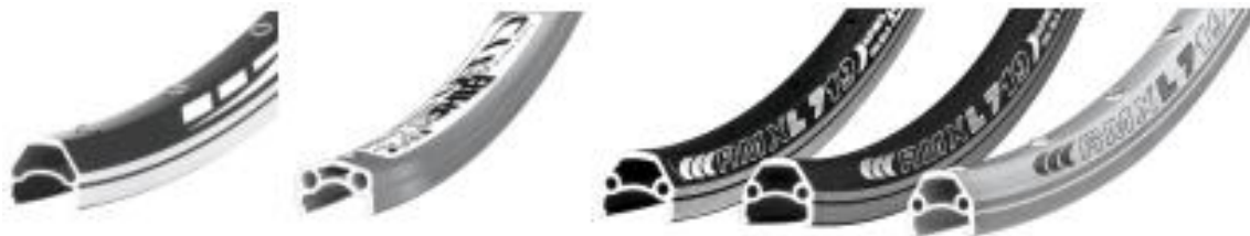
Obr. 29 Konstrukce ráfků pro cestovní a městská kola [6]
