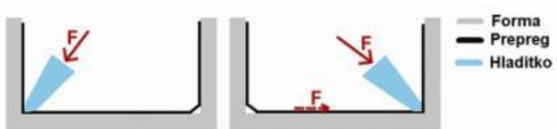
Obr. 24 Schéma skládání prepregu do formy [9]
