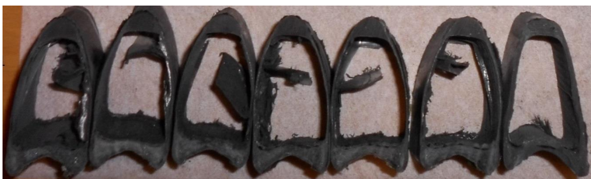
Obr. 116 Zkušební vzorky pro tlakovou zkoušku z použitých ráfků č.1
