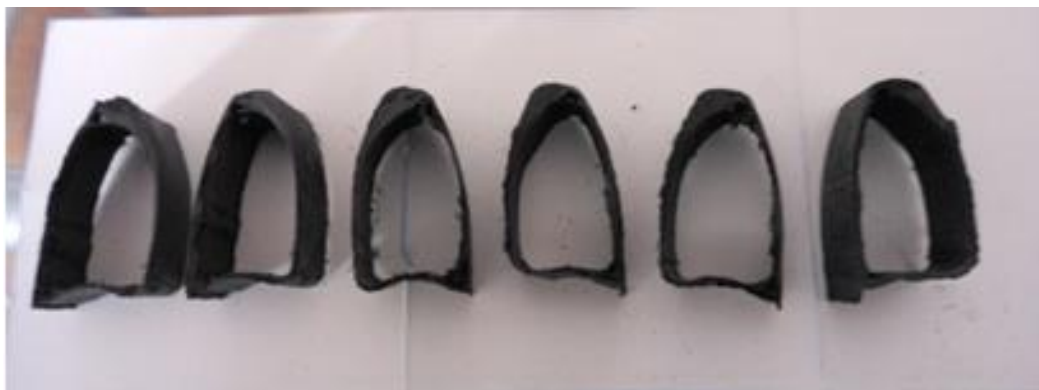
Obr. 115 Zkušební vzorky pro tlakovou zkoušku z prototypu
