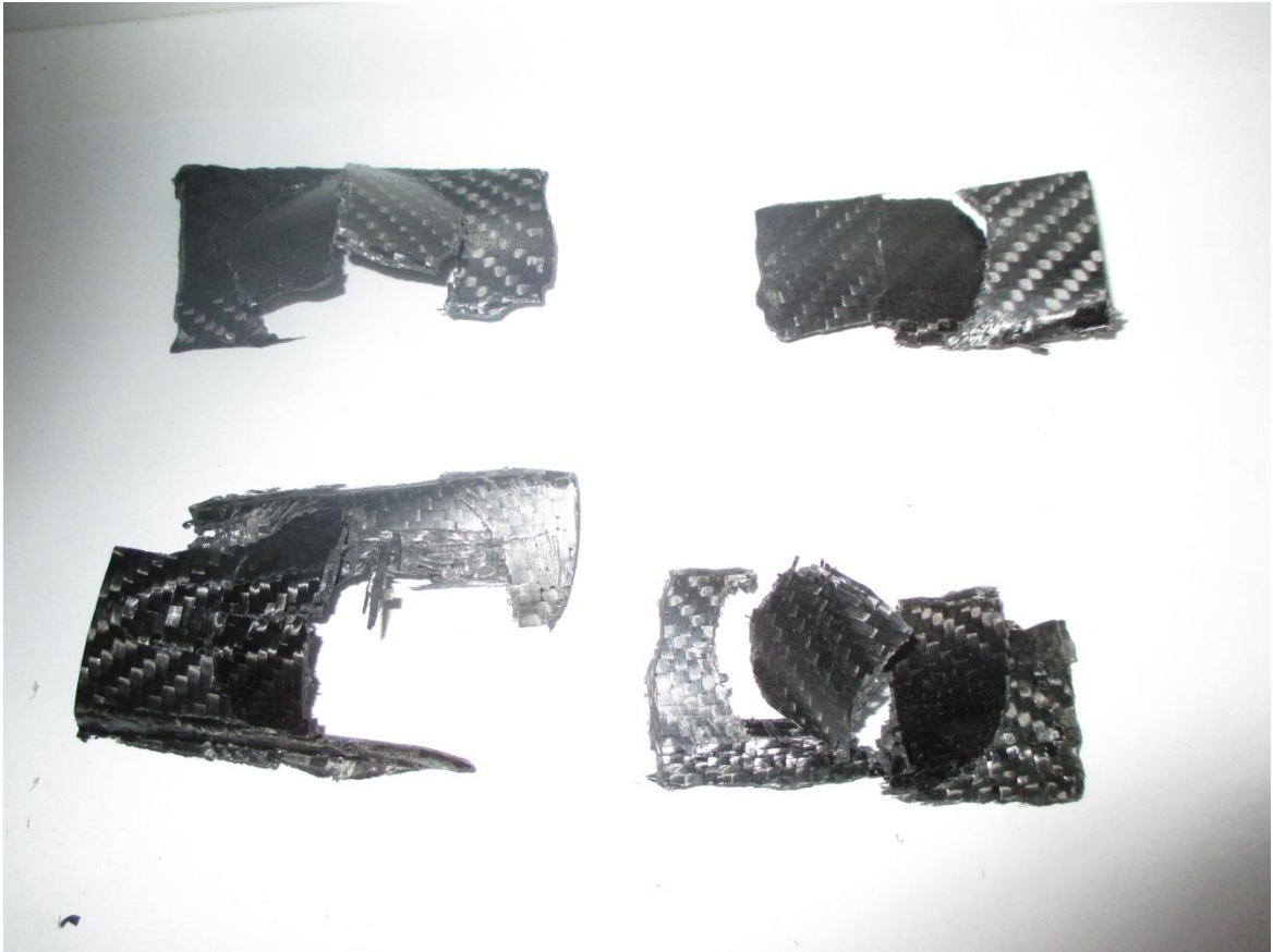
Obr. 133 Zkušební série prototypu po Impact testu
