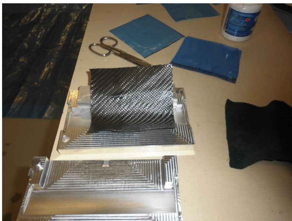
Obr. 75 Vložení prepregu do formy
