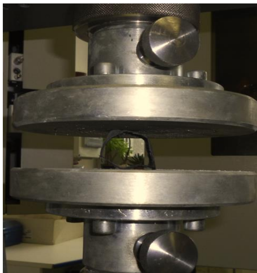
Obr. 122 Zkušební prototypový vzorek před tlakovou zkouškou
