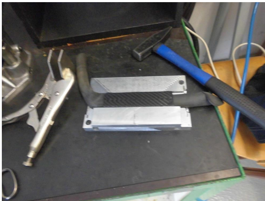
Obr. 82 Spodní díl formy s vytvrzeným prepregem
