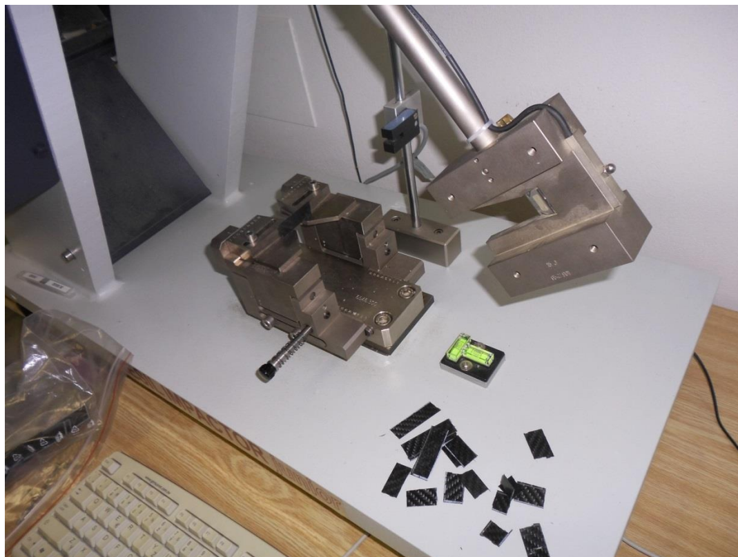
Obr. 107 CEAST Resil Impactor Junior během rázové zkoušky
