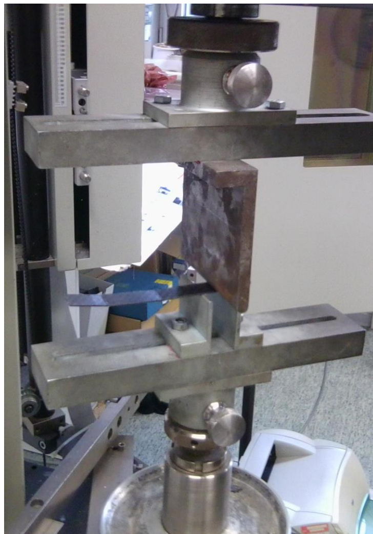
Obr. 104 Zkušební pásek mezi trnem a podpěrami
