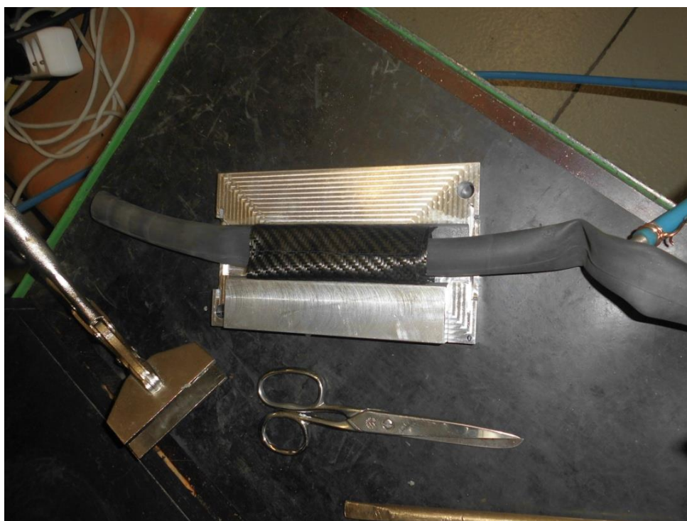
Obr. 77 Spodní část formy s prepregem s duší a svorkou před použitím
