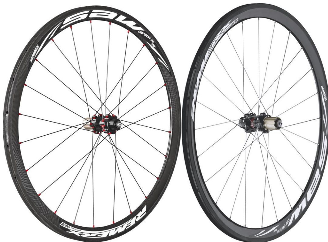
Obr. 55 Boční pohledy na zapletené kolo s karbonovým ráfkem SAW 38 [30]
