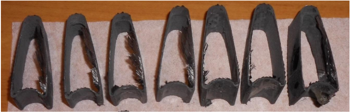
Obr. 119 Zkušební vzorky pro tlakovou zkoušku z použitých ráfků č.4
