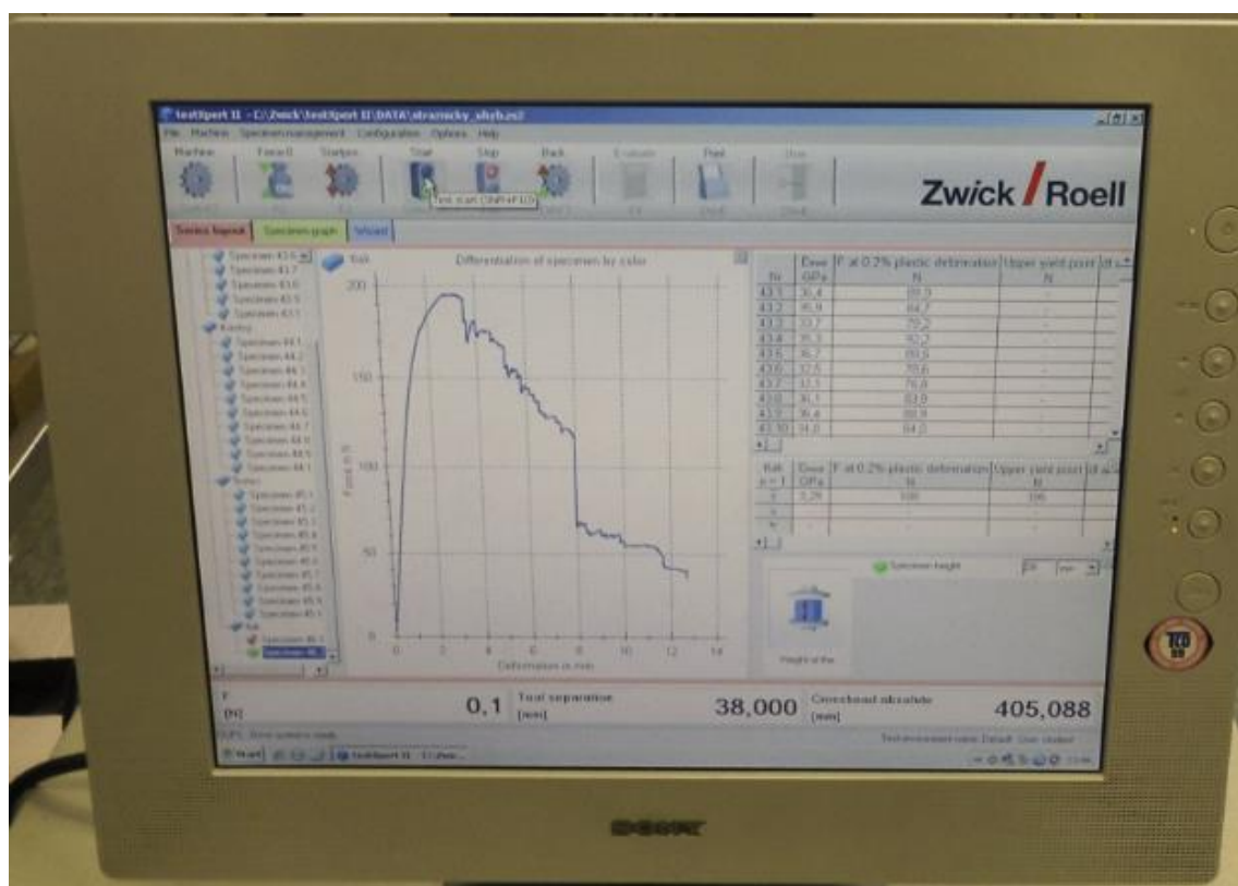
Obr. 125 Průběh zatěžování prototypového vzorku při tlakové zkoušce
