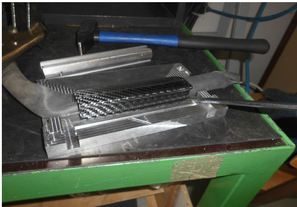
Obr. 84 Vyjímání vytvrzeného prepregu s duší ze spodní části formy
