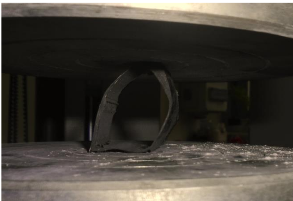
Obr. 124 Detail zkušebního prototypového vzorku při tlakové zkoušce
