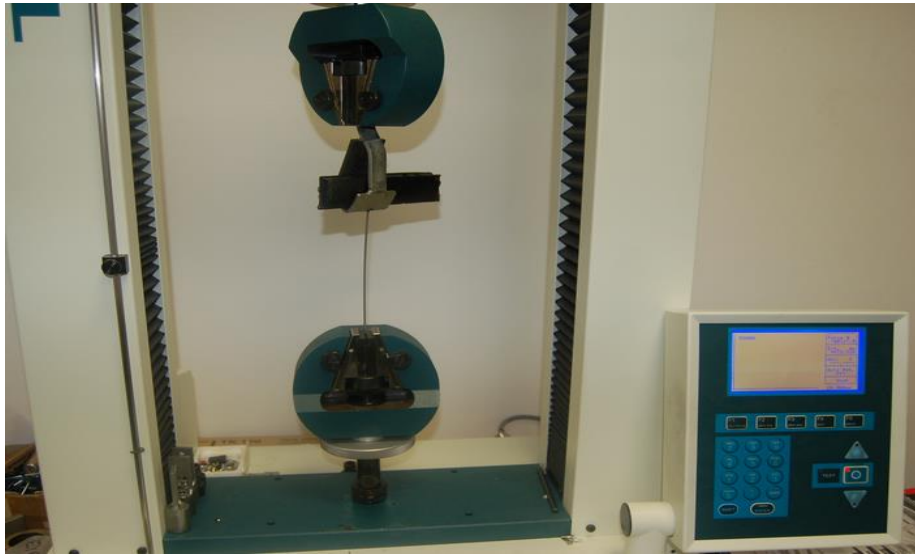
Obr. 90 Testování profilu se špicí v trhacím stroji
