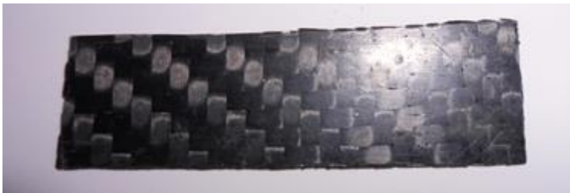
Obr. 109 Zkušební vzorek 15 x 50 x 0,5 mm pro rázovou zkoušku
