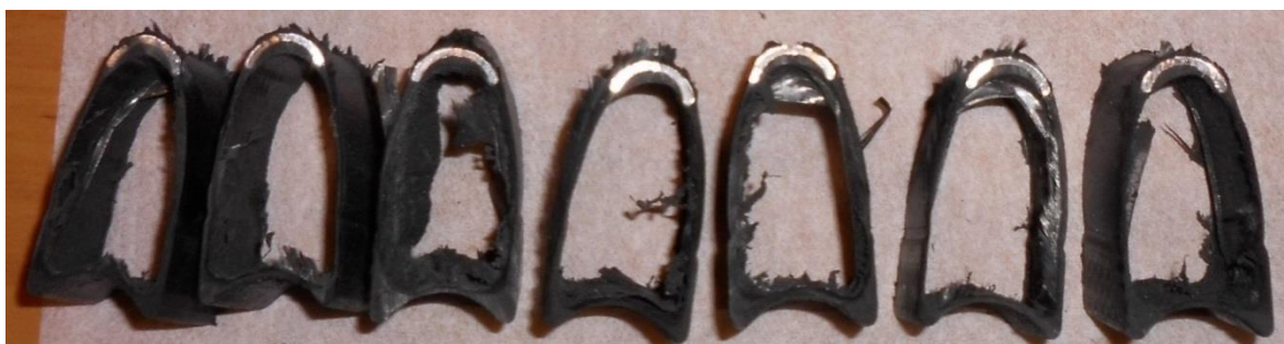
Obr. 118 Zkušební vzorky pro tlakovou zkoušku z použitých ráfků č.3
