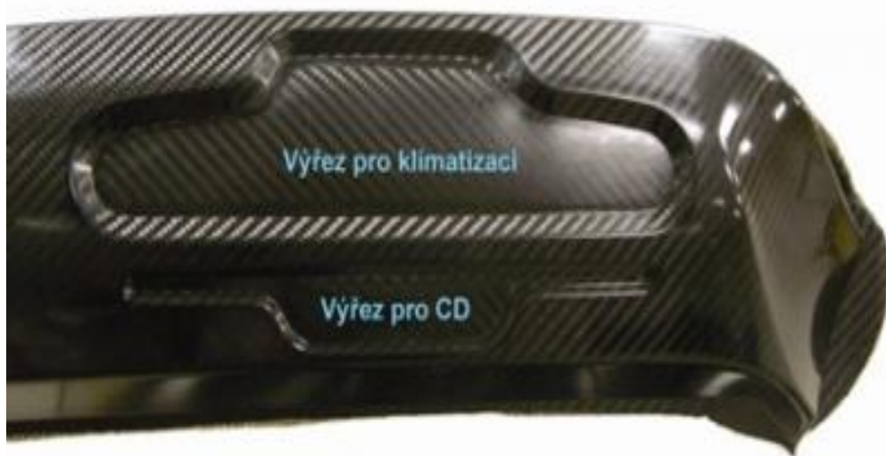
Obr. 25 Pohled na přechod snopců vláken v ostrém rádiusu [9]
