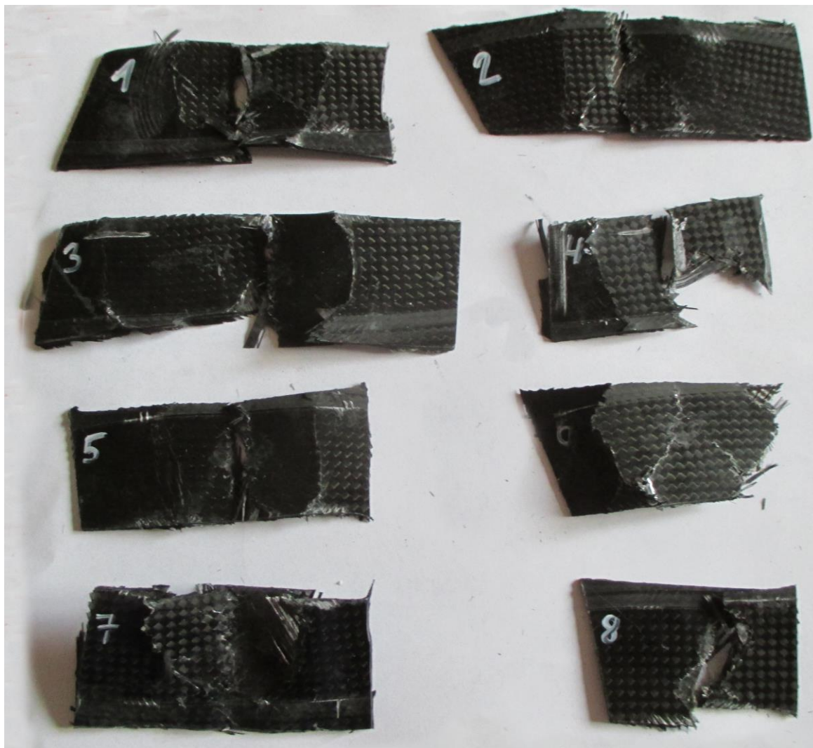
Obr. 132 Zkušební vzorky č. 1 až 8 po Impact testu
