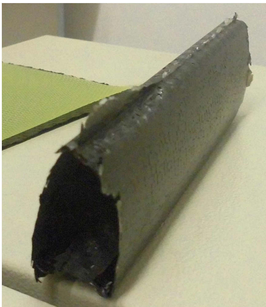
Obr. 87 Čelní pohled na vytvrzený profil po vyjmutí z formy
