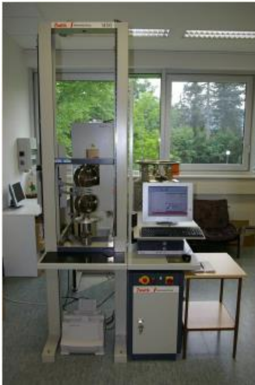
Obr. 102 Univerzální testovací stroj Zwick Roell 1456 [37]
