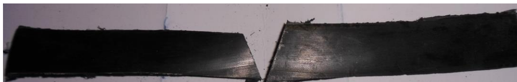
Obr. 127 Zkušební vzorky č. 3 a 5 pro Impact test
