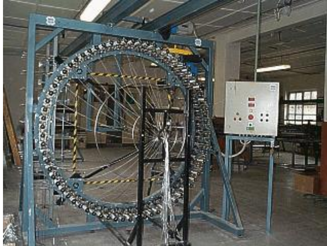
Obr. 2 Výroba triaxiálního nápletu [2]
