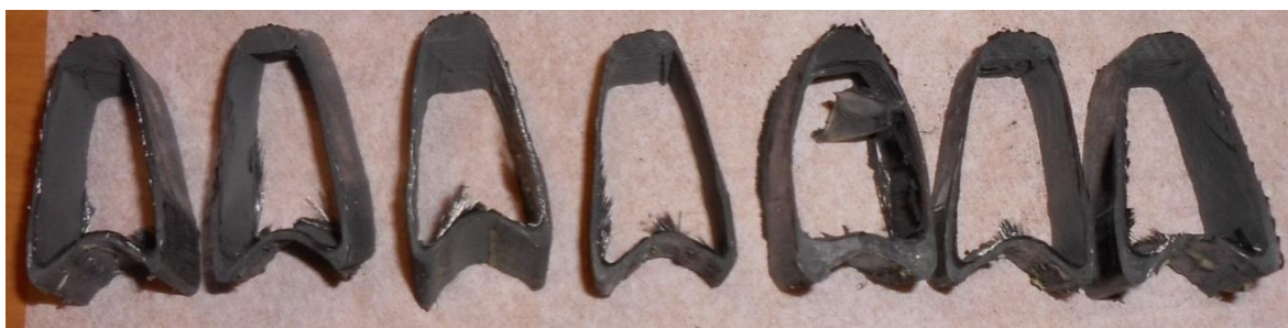
Obr. 117 Zkušební vzorky pro tlakovou zkoušku z použitých ráfků č.2
