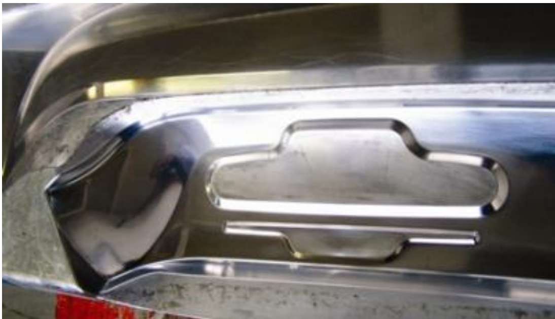
Obr. 21 Detail formy připravené ke skladbě [9]
