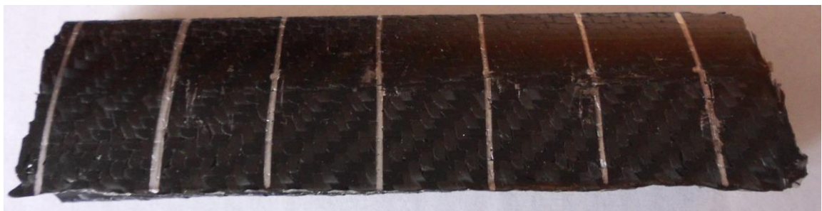
Obr. 114 Příprava prototypu k rozřezání pro tlakovou zkoušku
