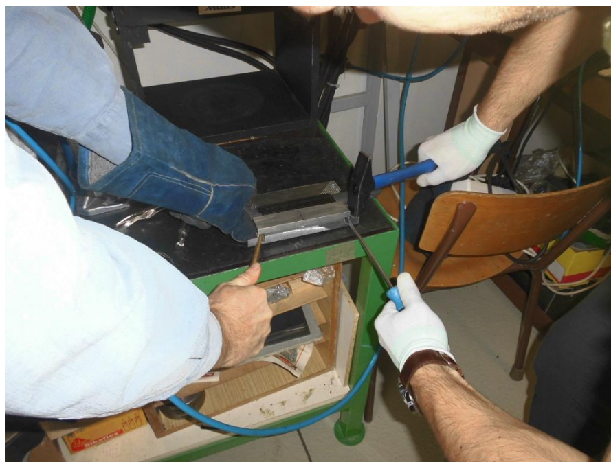
Obr. 83 Vyjímání tvarové kostky ze spodního dílu formy
