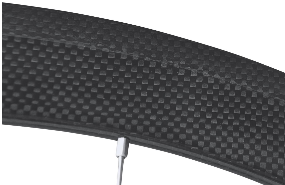
Obr. 56 Detail bočního pohledu na zapletené kolo s karbonovým ráfkem SAW 38 [30]
