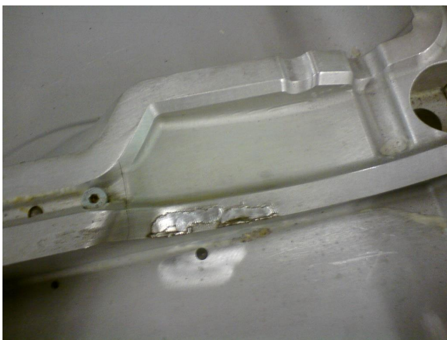
Obr. 43 Navaření v dělicí rovině
