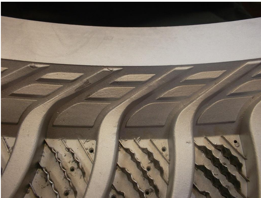
Obr. 62 Opravený dezénový segment formy
