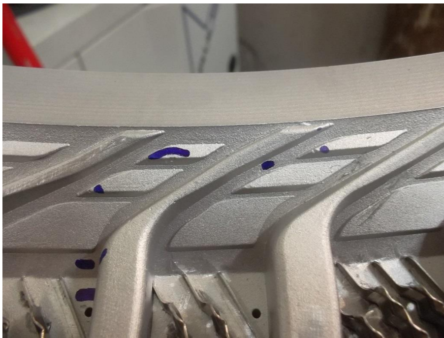
Obr. 60 Označené vady na odlitku segmentu
