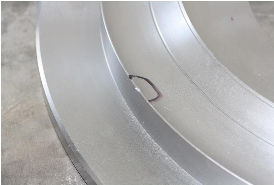
Obr. 36 Příprava pro navaření v bočnici
