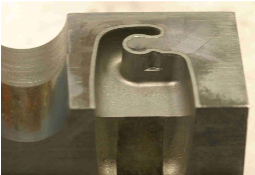
Obr. 49 Navařená hrana po přebroušení
