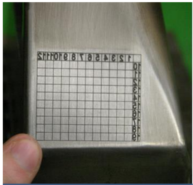
Obr. 51 Renovovaná plocha a nové datumové pole
