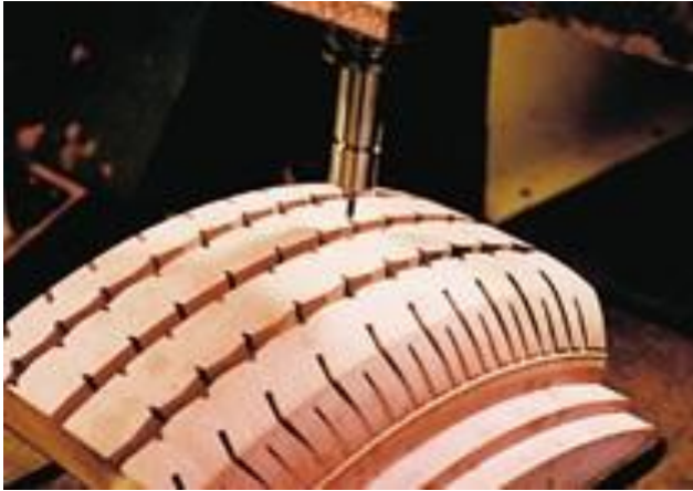
Obr. 27 Výroba odlévacího modelu segmentu pláště pneumatiky [28]
