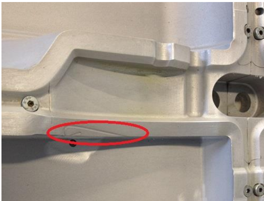
Obr. 42 Poškození dělicí roviny chybou obsluhy
