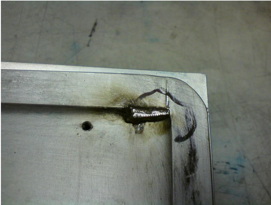
Obr. 46 Návar v místě tvarové změny
