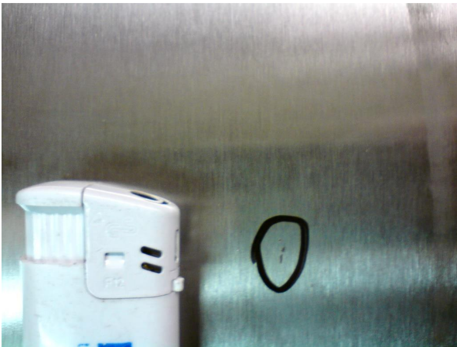
Obr. 39 Vada v materiálu
