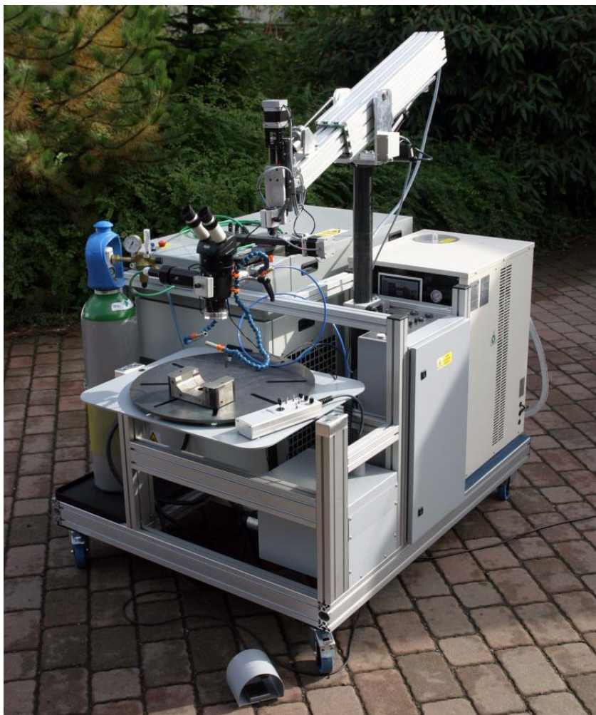
Obr. 35 Laserový navařovací systém ACP C150
