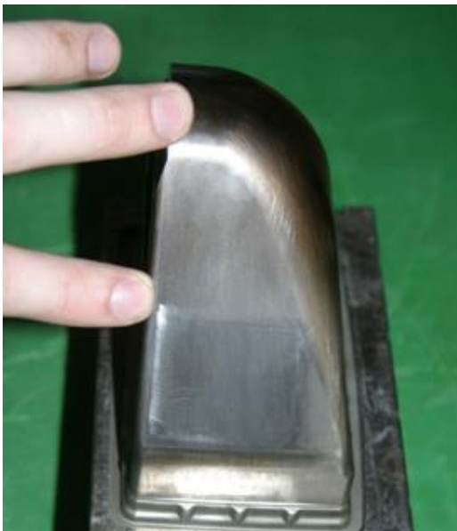
Obr. 51 Renovovaná plocha a nové datumové pole
