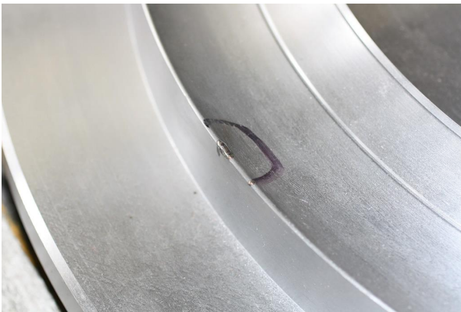
Obr. 37 Navaření hrany bočnice
