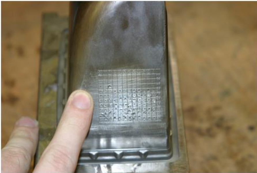
Obr. 50 Datumové pole před opravou
