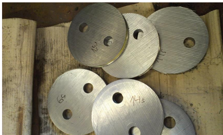
Obrázek 61 Nařezané kotouče, určené k odjehlení
