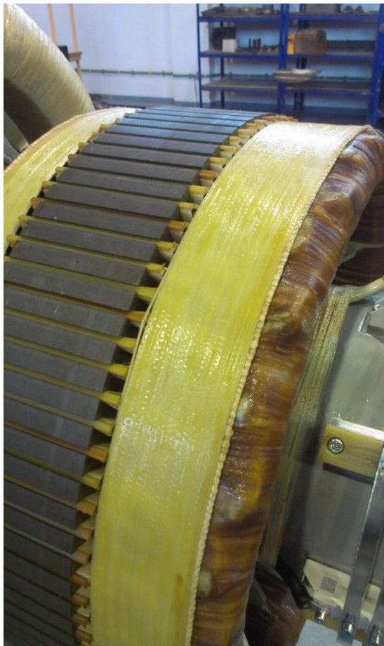
Obrázek 29 Strojově vyráběná bandáž rotoru budiče
