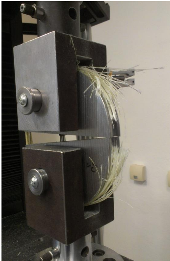
Obrázek 64 Bandáž po přetržení
