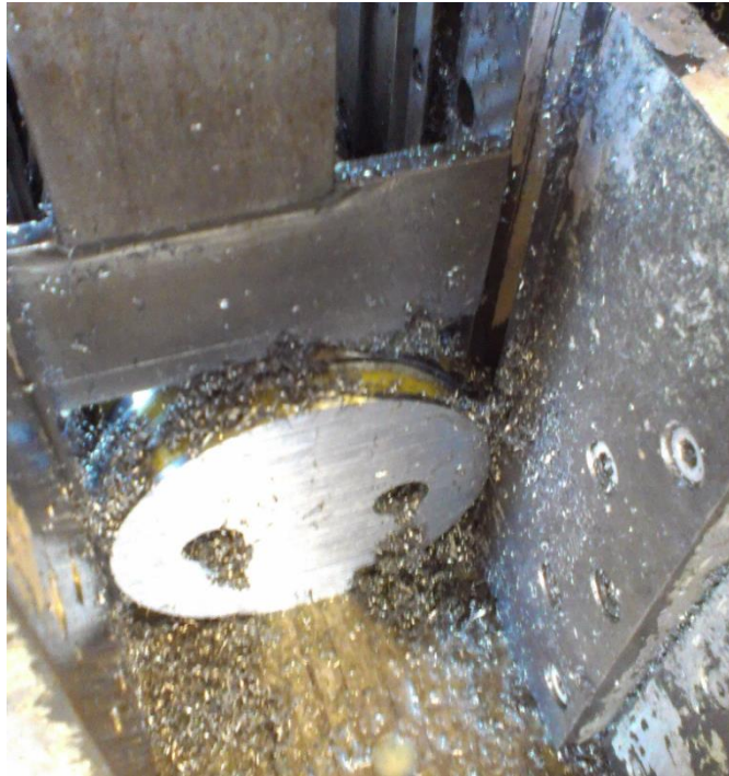
Obrázek 60 Řezání kotoučů s bandáží
