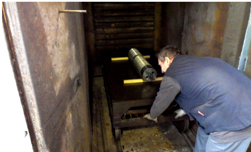
Obrázek 59 Vložení bandáží do vytvrzovací pece
