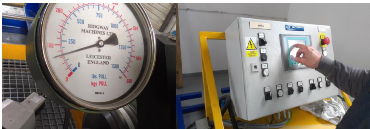
Obrázek 52 Nastavení otáček a předpětí pomocí kalibrované brzdy
