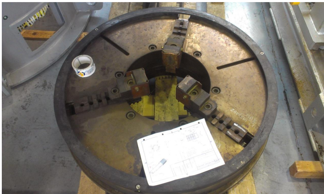
Obrázek 31 Skličidlo pro upínání rotorů určených ke strojní bandáži
