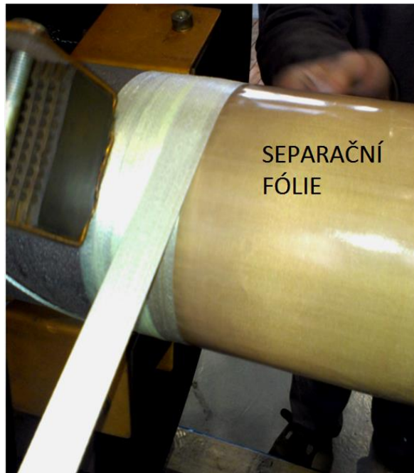
Obrázek 69 Navíjení pásky na separační fólii.
