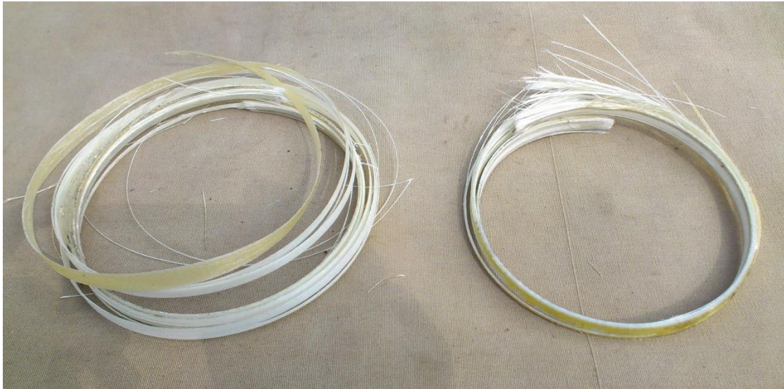
Obrázek 75 Vlevo ručně navíjený NOL-Ring; vpravo strojně navíjený
