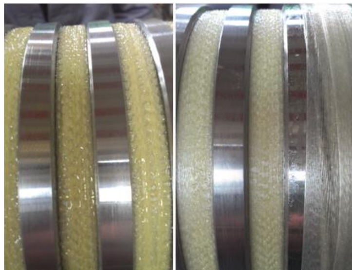
Obrázek 57 Vlevo strojní bandáž, vpravo ruční bandáž
