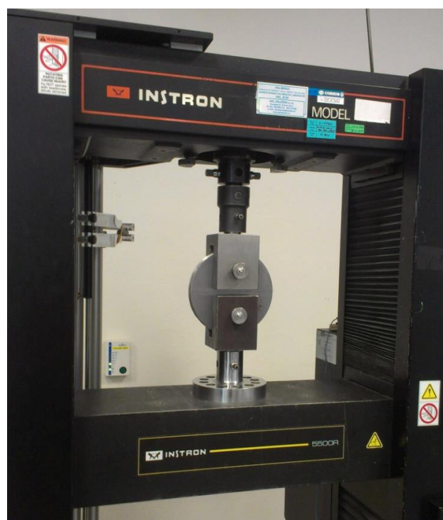
Obrázek 63 Ustavený přípravek na stroji
