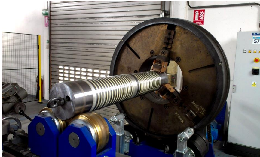
Obrázek 58 Hotová navinutá ruční i strojní bandáž na přípravku
