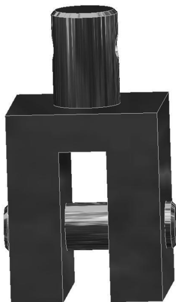
Obrázek 38 Upínací kostka s čepem pro uchycení nařezané bandážovací tyče
