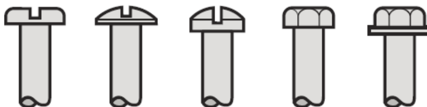
Obr. 2. Doporučované druhy šroubů [2]
