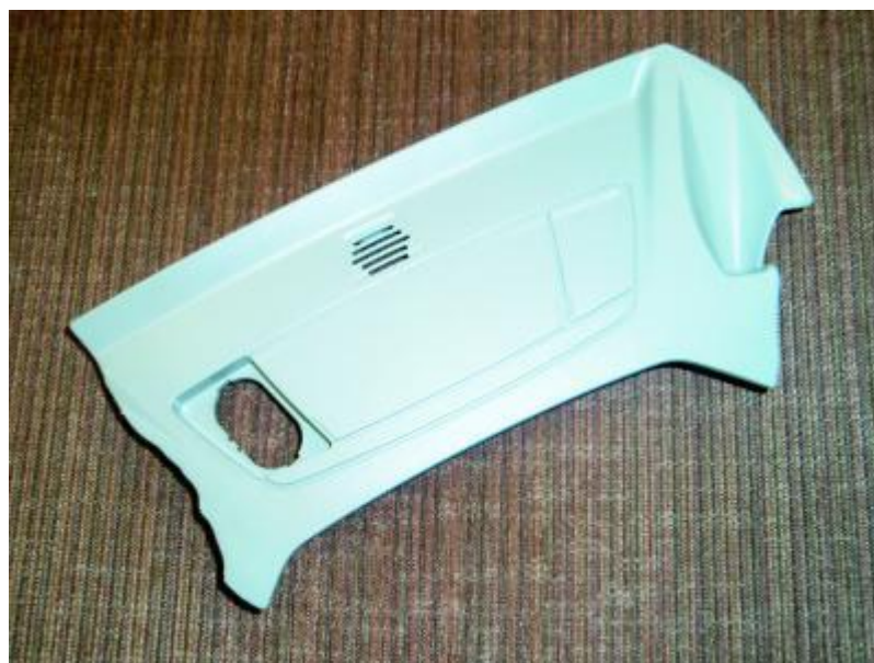
Obr. 18 Nedotečení taveniny na boční stěně výstříku [11]
