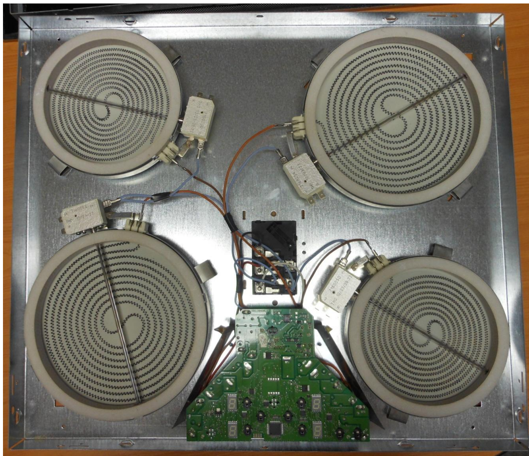
Obr. 17 Odkrytá varná deska
