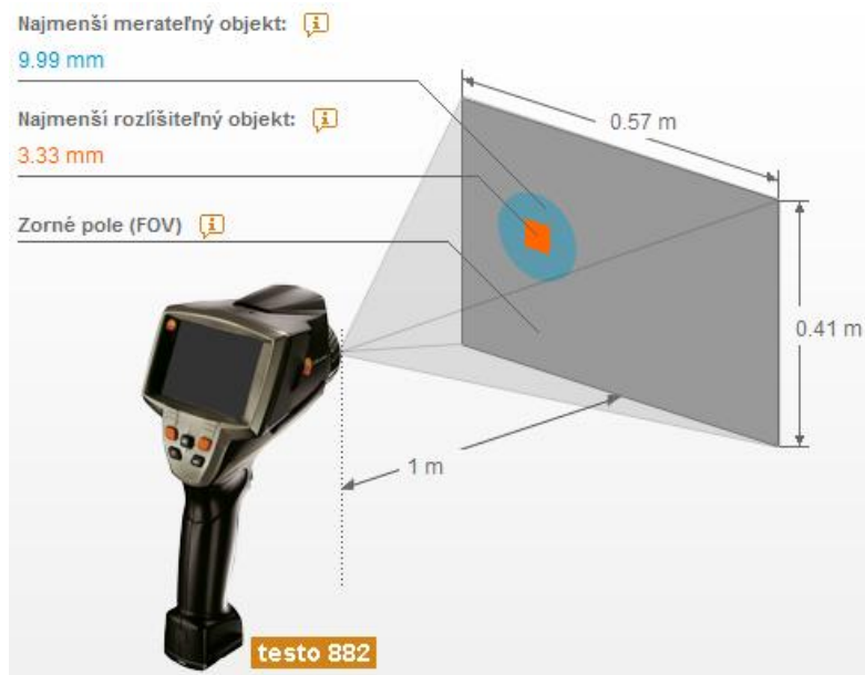
Obr. 10 Minimální vzdálenost snímače od měřené plochy dle požadavků firmy TESTO[13]
