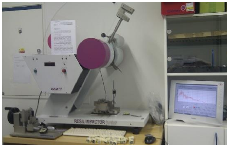
Obr. 23 Charpyho kladio (stroj Resil Impactor Junior)
