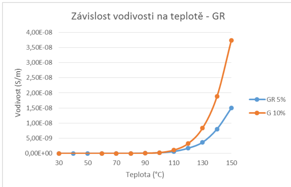
Obr. 31 Závislost vodivosti na teplotě - GR
