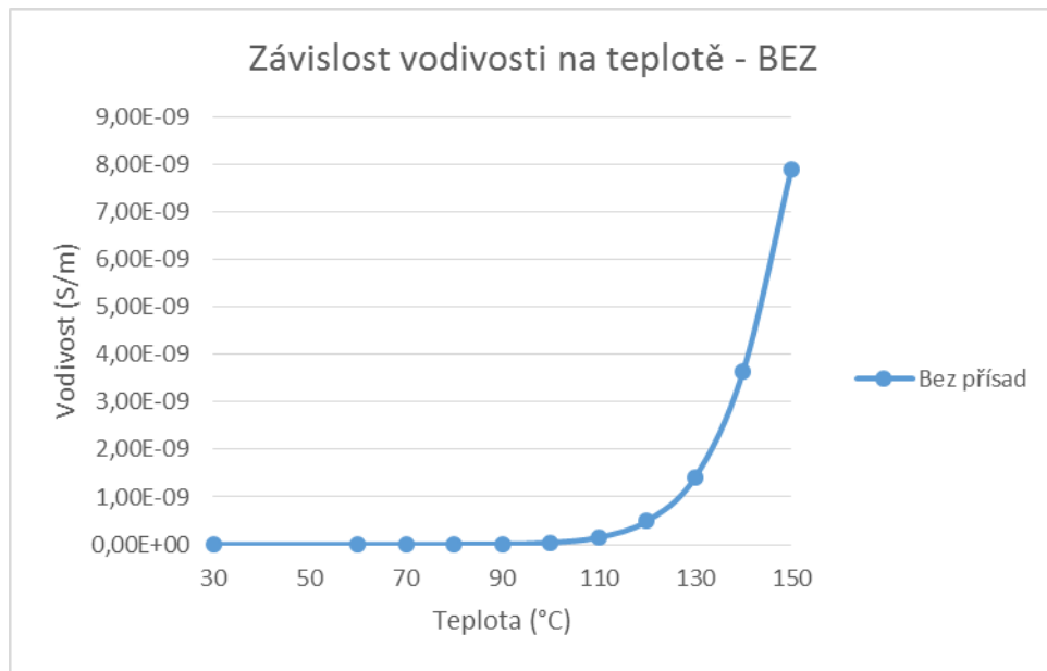
Obr. 25 Závislost vodivosti na teplotě - BEZ
