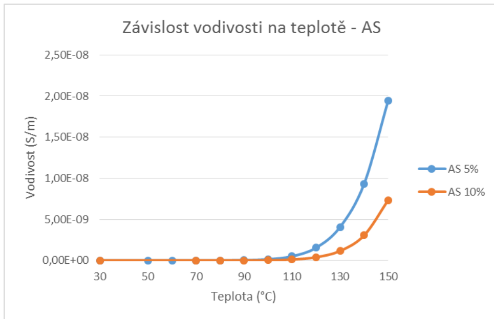
Obr. 29 Závislost vodivosti na teplotě – AS
