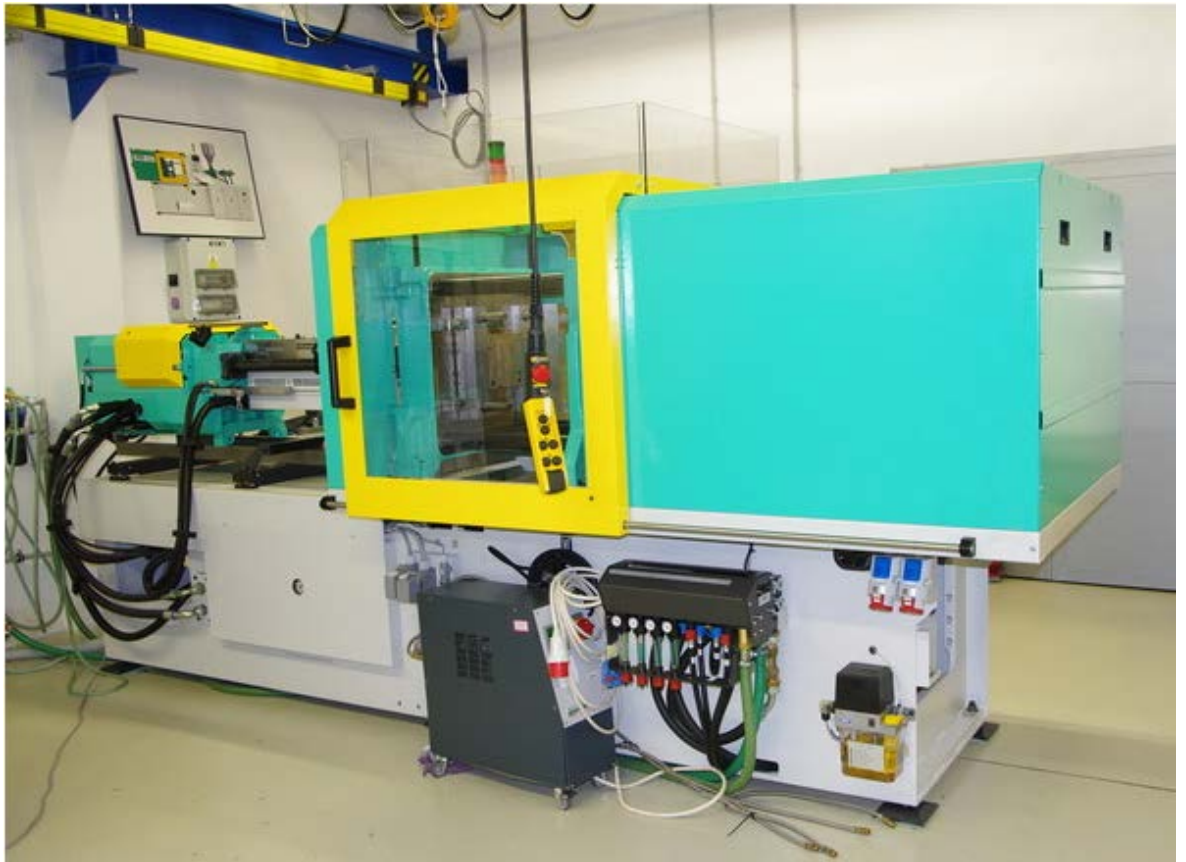
Obr. 2. Ukázka vstřikovacího stroje Arburg Allrounder 470 H 1000 – 400 na Ústavu výrobního inženýrství [19]
