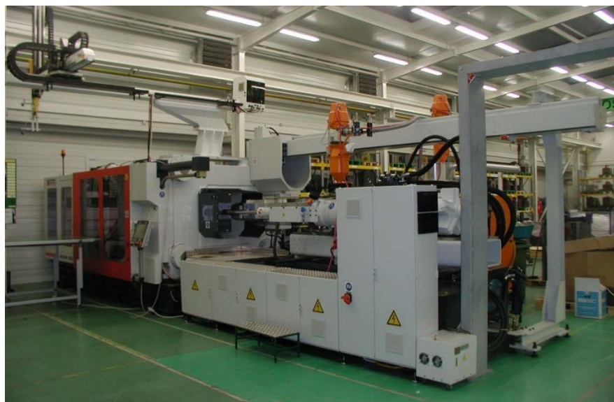
Obr. 36. Vstřikovací stroj Ferromatik Milacron
