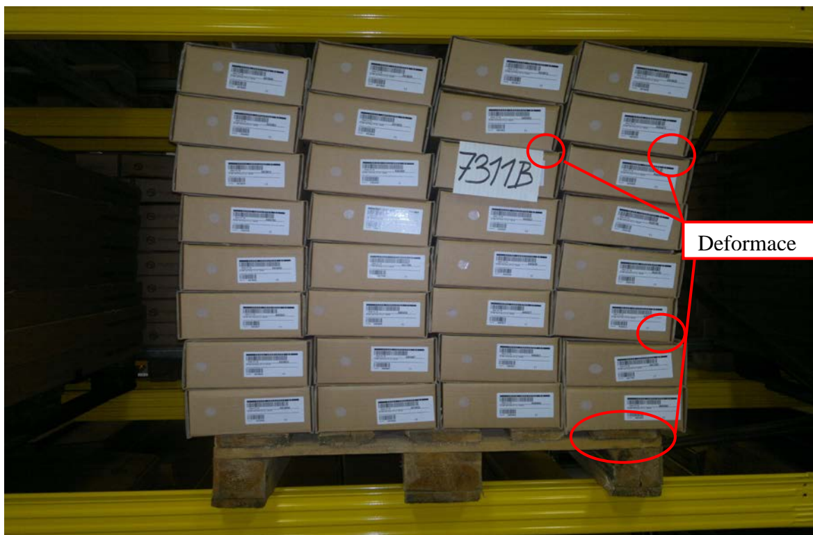
Obr. 18: Nestabilní uložení krabic na paletě a alokace vybraných deformačních zón
