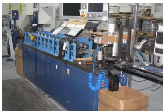
Tabulka 3 Část výrobního procesu - válcování a nýtování lamel
