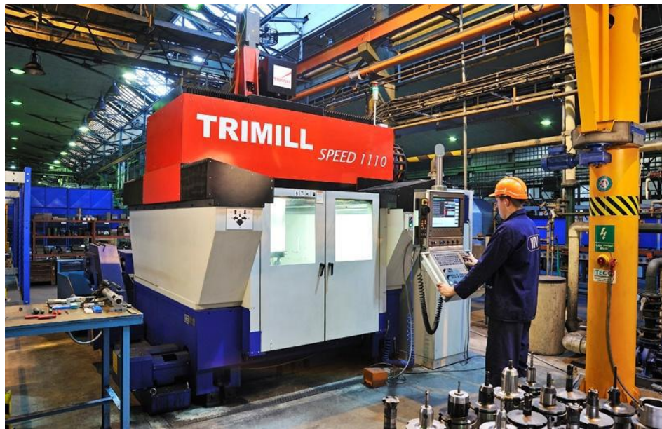
Obrázek 26 – obráběcí centrum Trimill Speed 1110 (interní materiály)
