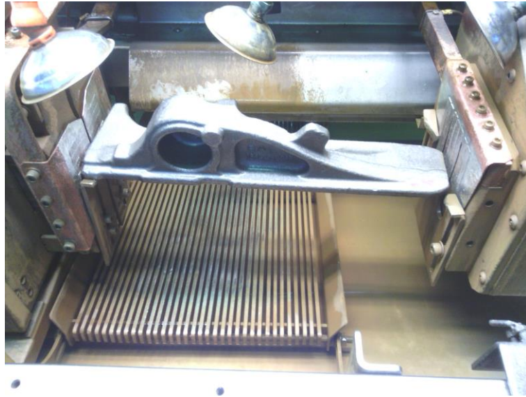
Obrázek 31 – sevření výkovku v čelistech stroje (vlastní zpracování)
