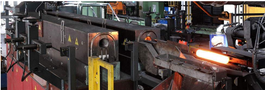
Obrázek 25 – ohřev naděleného materiálu pomocí induktoru (interní materiály)
