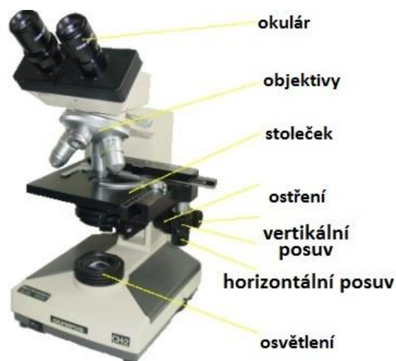
Obrázek 17 - Konstrukce a princip optického mikroskopu [43].
