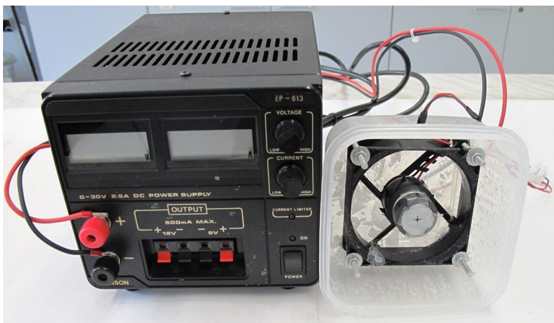
Obrázek 22 – Home-made spin-coater – zkonstruovaný pro depozici tenkých polymerních vrstev v laboratoři UFMI, FT, UTB ve Zlíně.
