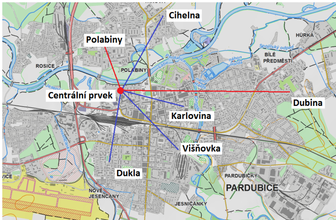
Obr. 17. Mapa páteřní sítě - červeně optické trasy, modře bezdrátové spoje (mapový podklad ČÚZK).
