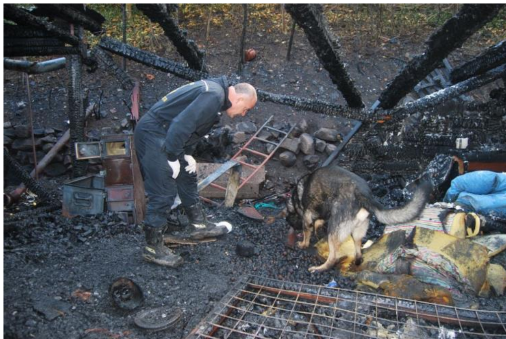
Obrázek 17 Využití psa při zjišťování akcelrantů na místě požáru. [23]
