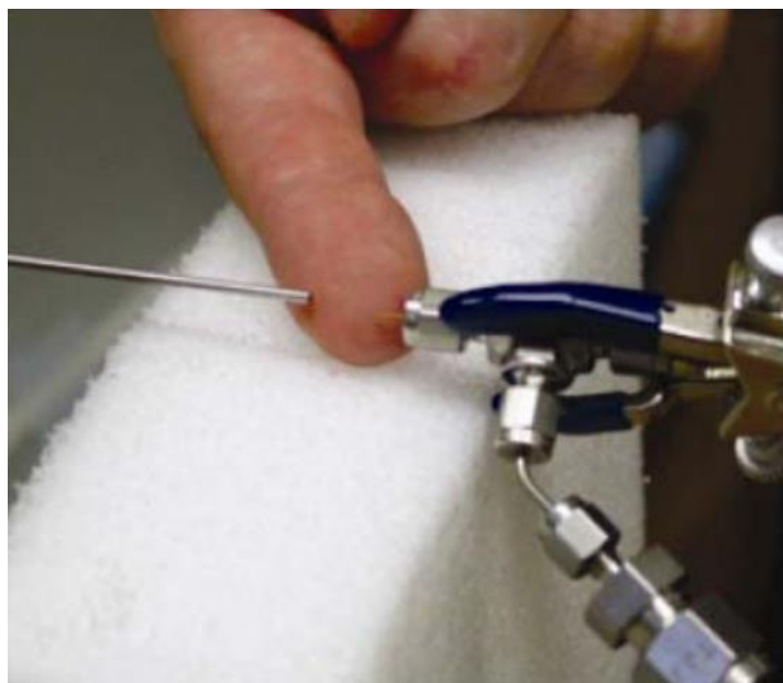
Obrázek 9. Vzorek z prstu pomocí DESI [7]
