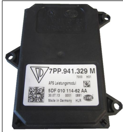
Obr. 21 – LEIMO – napájecí modul
