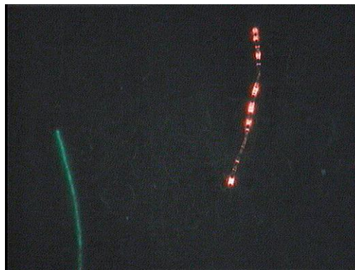
Obr. 15: Luminiscence ochranného vlákna [13]
