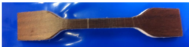
Obr. 16 Praskání horní a dekorační vrstvy při vysekávání u vzorku A7 ve směru příčném
