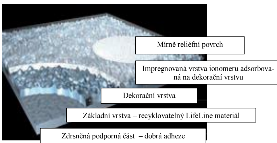
Obr. 12 Struktura LifeLine podlahoviny [47]
