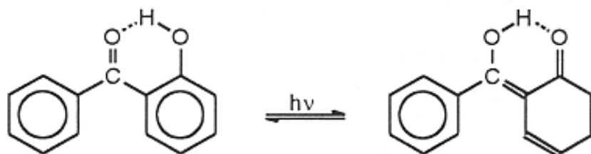
Obr. 3 Mechanismus disipace UV záření [7]
