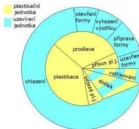
Obr. 3 Schéma vstříkovacího cyklu
