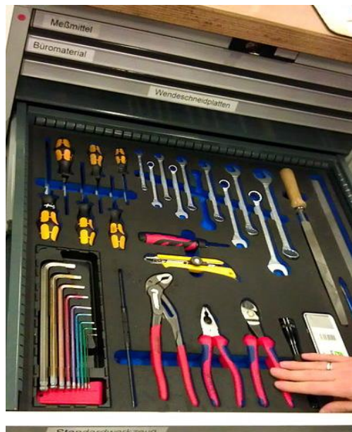
Obr. 13 Příklad uspořádání nástrojů v šuplíku podle 5S (Wikipedia, 2011)
