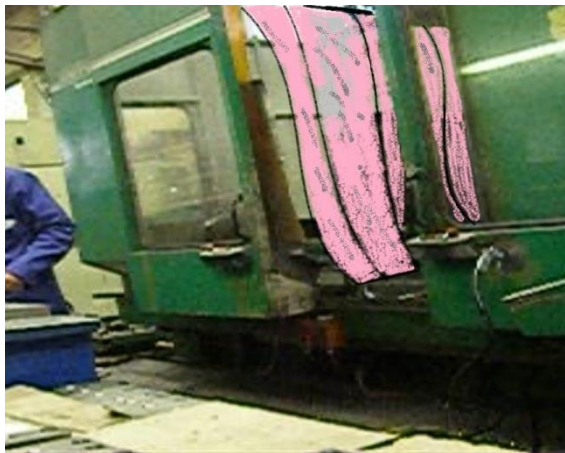
Obr. 43 Rozdělení boxů pomocí tkaninové odnímatelné přepážky (vlastní zpracování)
