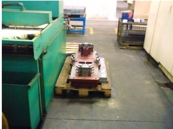
Obr. 21 Přípravek odložený v logistické cestě (vlastní zpracování)
