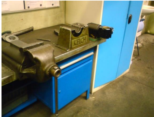
Obr. 19 Odkládací skříňka a stůl pro montáž nových nástrojů (vlastní zpracování)
