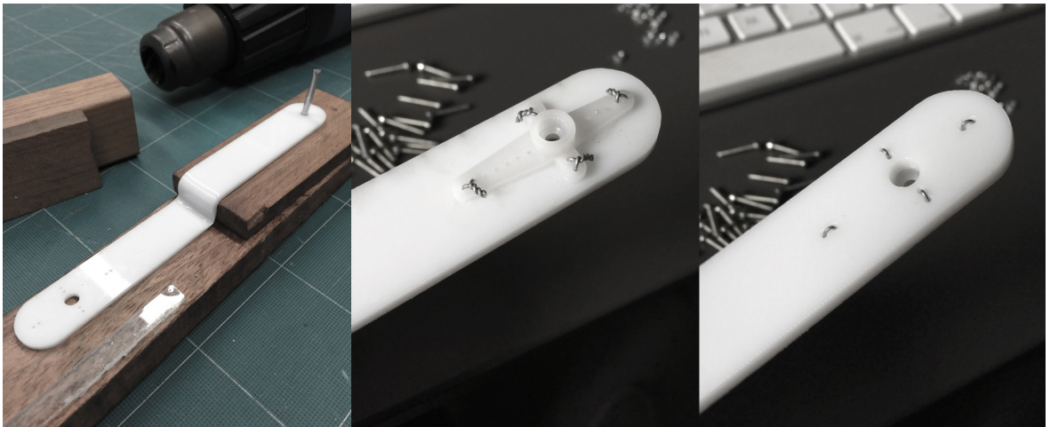
Obr. 27. postup výroby ramena, pripevnenie nástavca k servu
