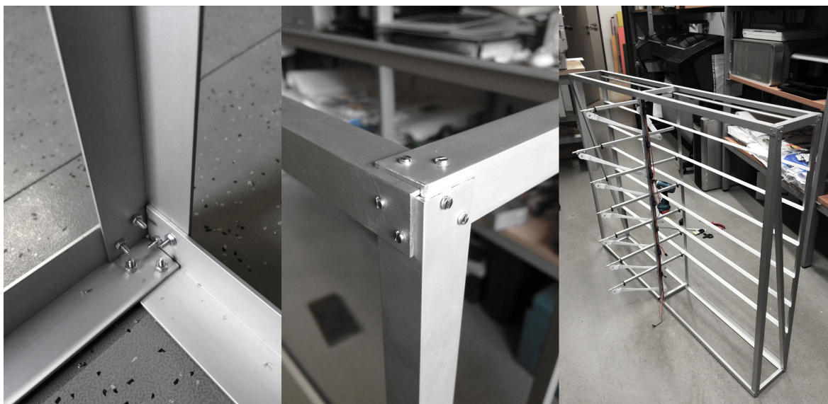
Obr. 31. základná hliníková konštrukcia, rohový spoj
