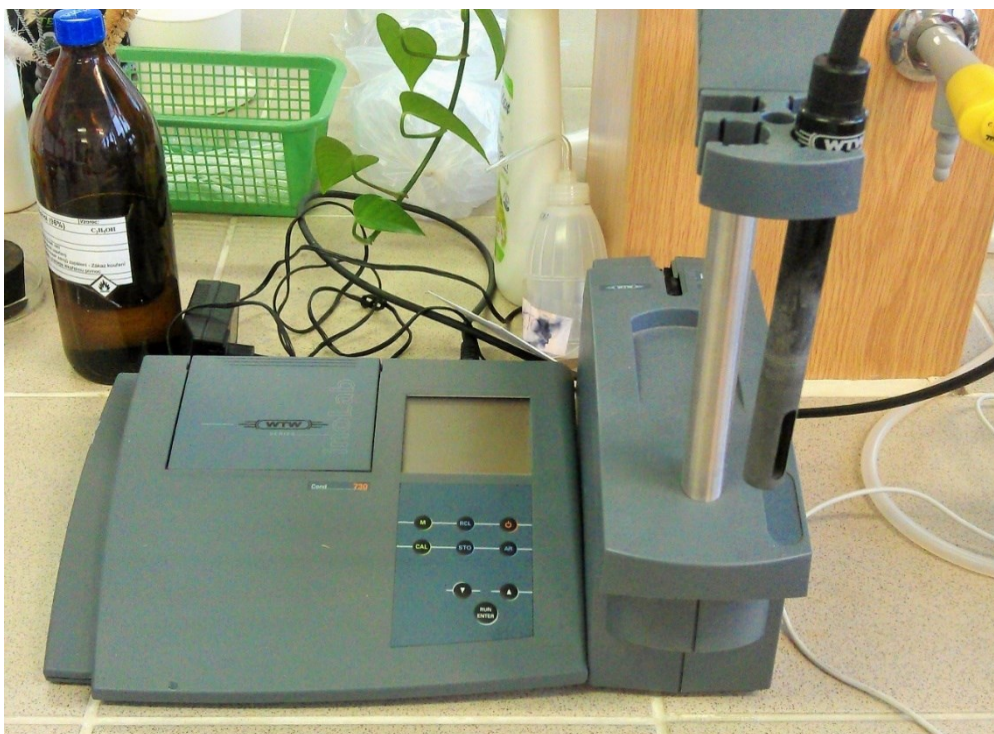
Obr. 24 Aparatura pro konduktometrickou titraci
