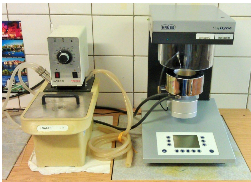
Obr. 25 Použitá aparatura pro stanovení povrchového napětí
