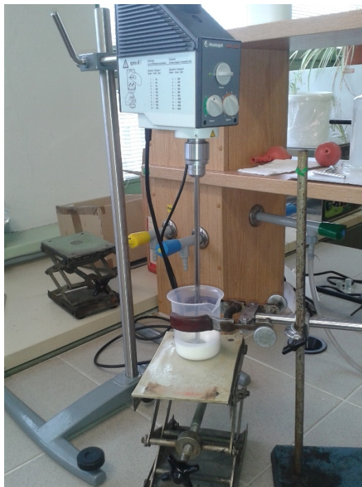
Obr. 9. Aparatura pro homogenizaci emulze pomocí míchadla RZR 2020
