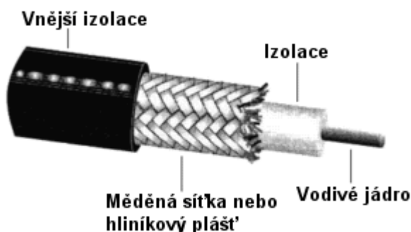
Obr. 9 Jednotlivé vrstvy koaxiálního kabelu [7]
