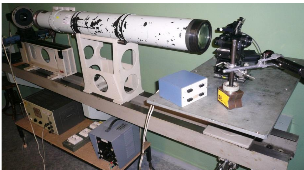
Obr. 43 Zaostření kolimátoru na nekonečno
