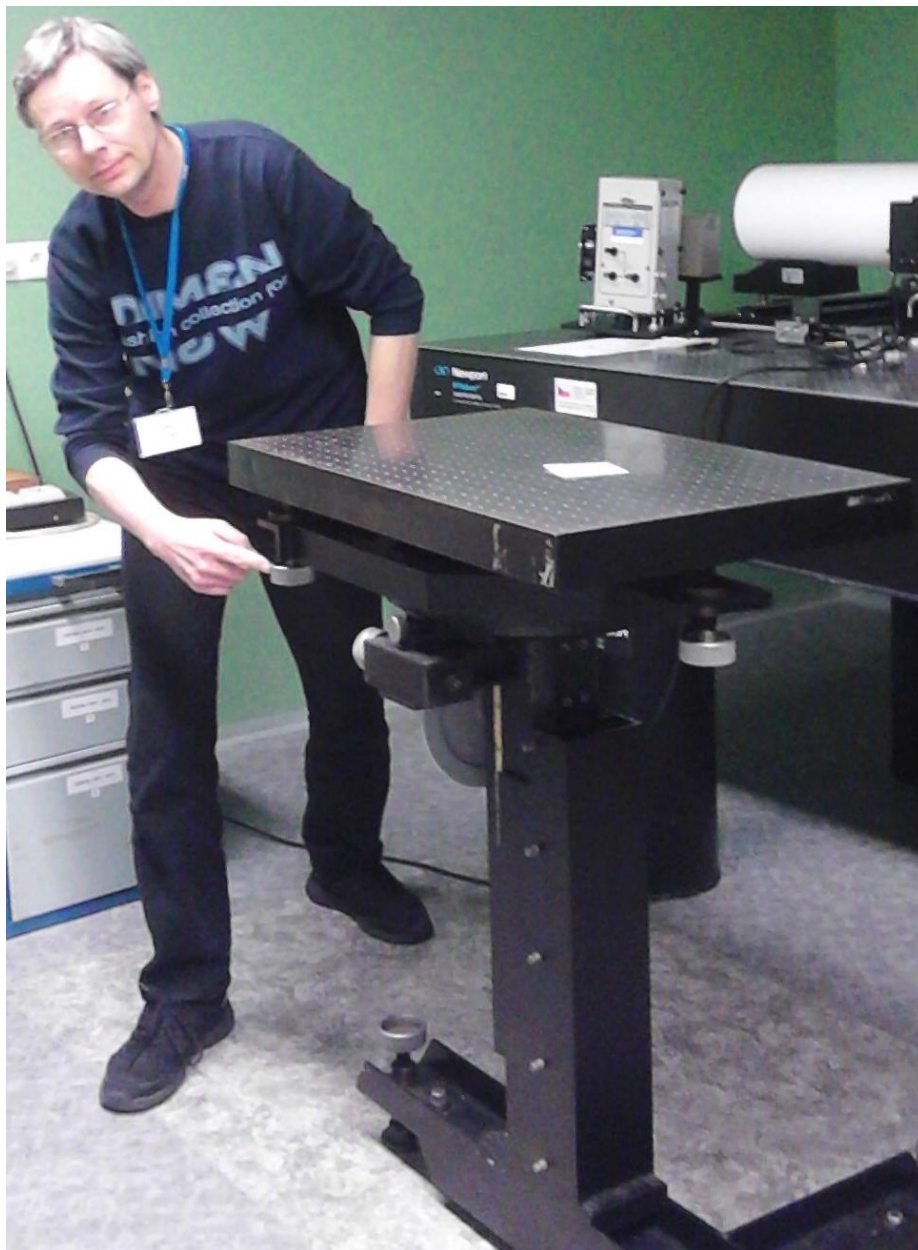
Obr. 36 Naklápění je zajištěno pomocí mechanických točítek
