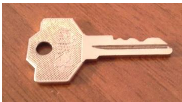
Obr. 23. Klíč k novým typům zámků na rozváděčích.
