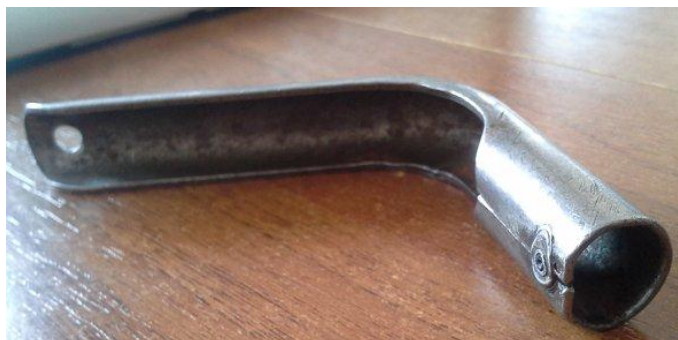
Obr. 20. Klíč k staršímu typu rozváděčů.
