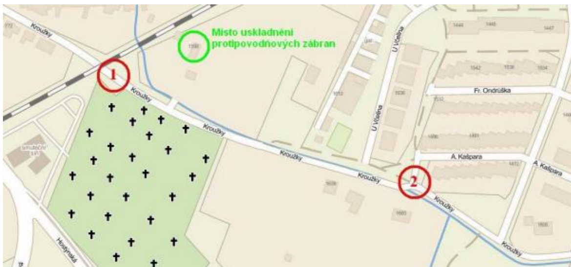
Obrázek 11. Místo uložení mobilních zábran a místa výstavby zábran [Zdroj:[14]]
