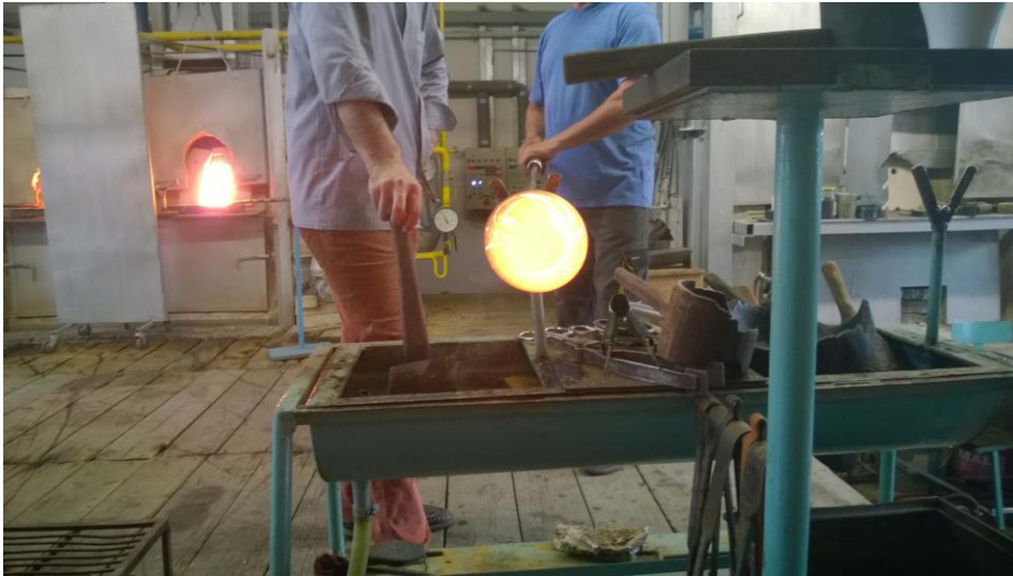
Obr. 39 práce na sklárně, foukání
