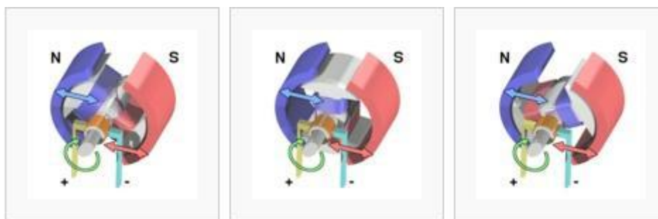
Obr.17.Princíp činnosti jednosmerného motora.
