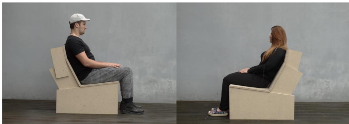
Obr. 35. Ergonomická studie, výška postavy 195cm a 160cm
