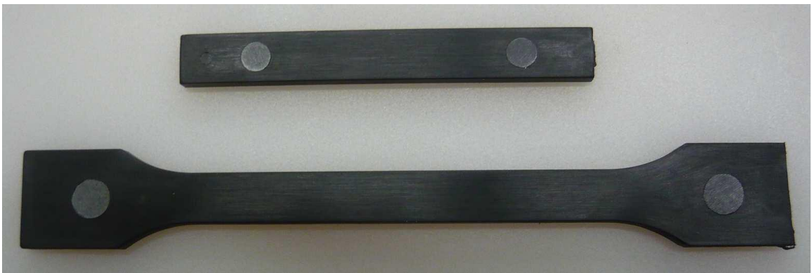
Obr. 17 Zkušební vzorek a pásek pro překlátování. [3]
