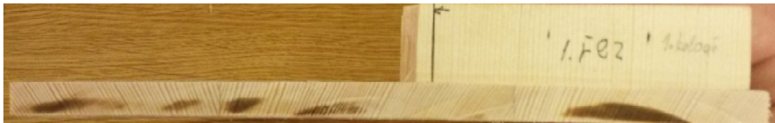
Obr. 45 Spálená místa ve zkušebním smrkovém vzorku, řez prvního kotouče.
