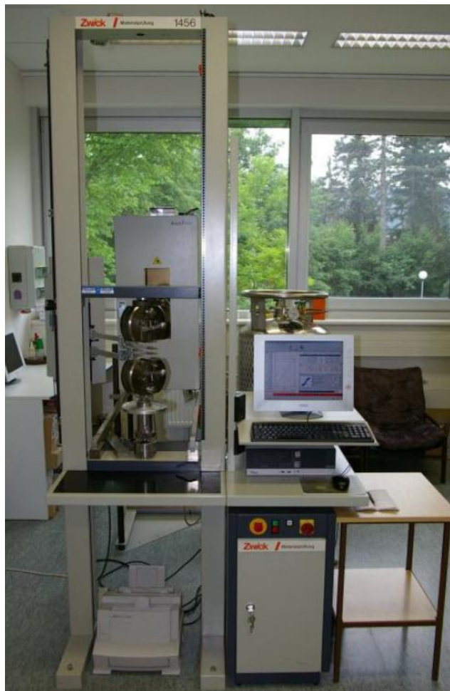
Obr. 37 Univerzální stroj ZWICK 1456 [27].
